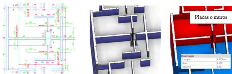
Figura 10. Secuencia de plano 2D a un modelo 3D y el modelo 4D
