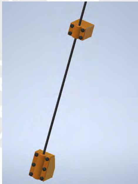
Figura 3.15 Barra de fibra de carbono con acoples de ABS
