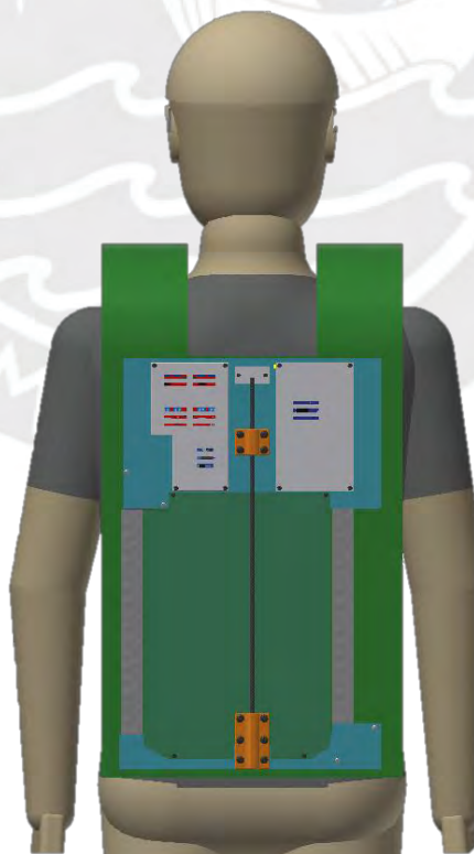
Figura 5.6 Integración de sistema con funda de material codra
