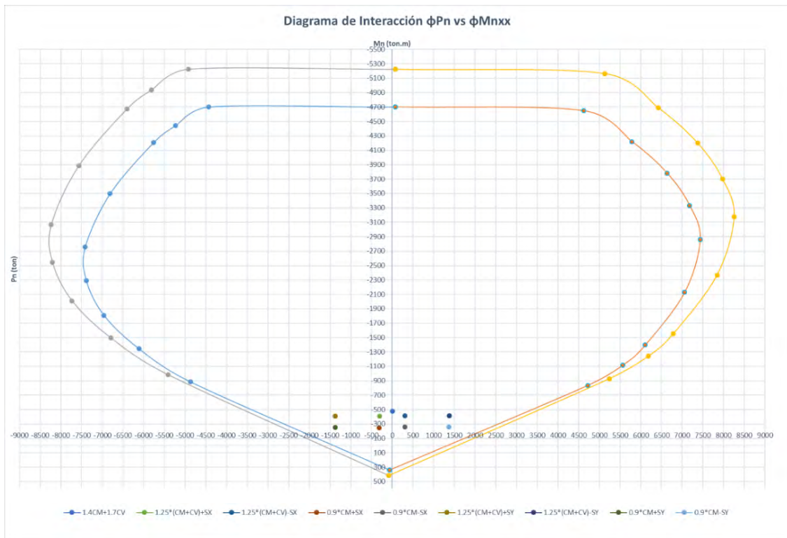
Figura 30. Diagrama de Interacción en dirección 3
