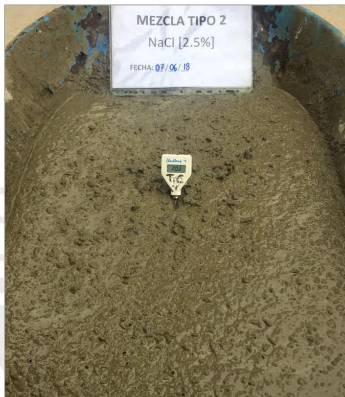
*Figura 27.* Muestreo de la mezcla de concreto MB-2.5%, adecuada apariencia inicial.
