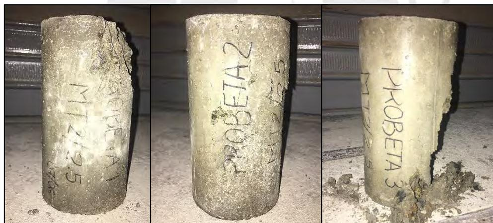
Figura 39. Probetas cilíndricas de la mezcla de concreto MB – 2.5% ensayadas a compresión
