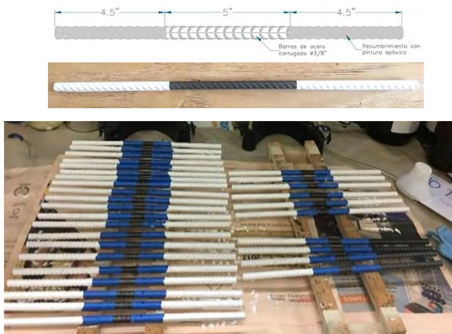
Figura 22. Preparación de barras de acero corrugado con pintura epóxica en sus extremos
