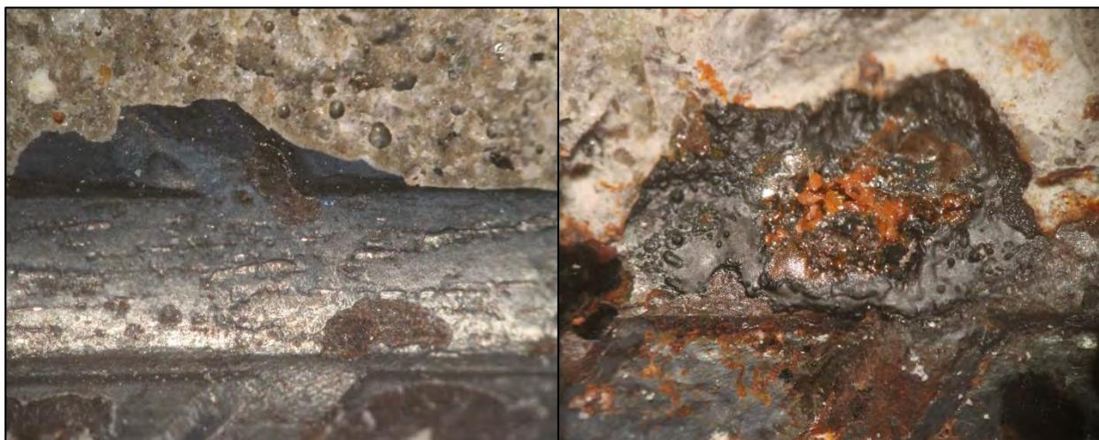
*Figura 55.* (Izquierda) Refuerzo sin daño. (Derecha) Refuerzo dañado por corrosión. Toma de micrografías a 1.6X, utilizando un estereomicroscopio marca Zeiss, modelo DRC.
