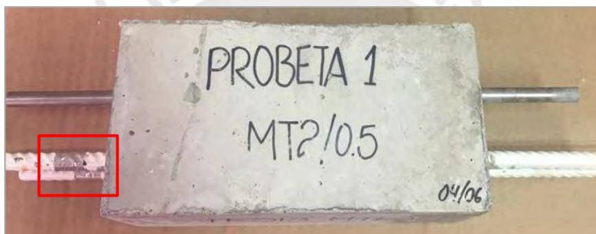
Figura 45. Acondicionamiento de probeta prismática para las mediciones electroquímicas
