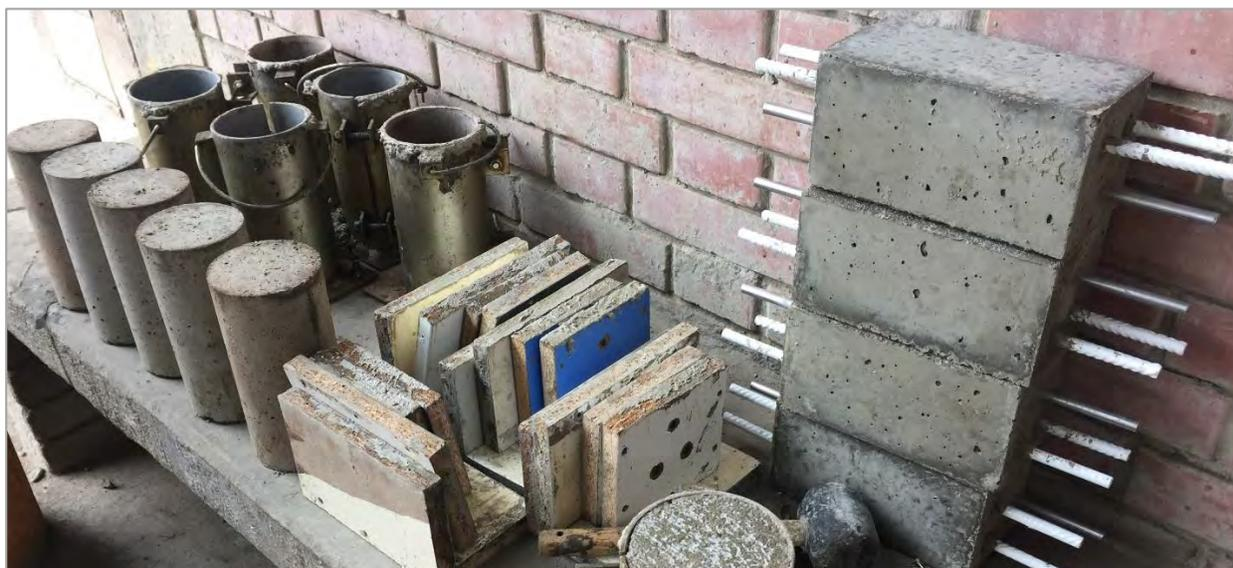
*Figura 37. Probetas cilíndricas y prismáticas desencofradas - moldes de metal y melamina.*
