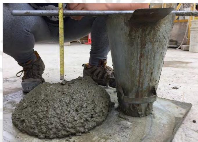
*Figura 25. Mezcla prueba N° 3 (MB-2.5%), slump 18 cm, con buena consistencia.*
