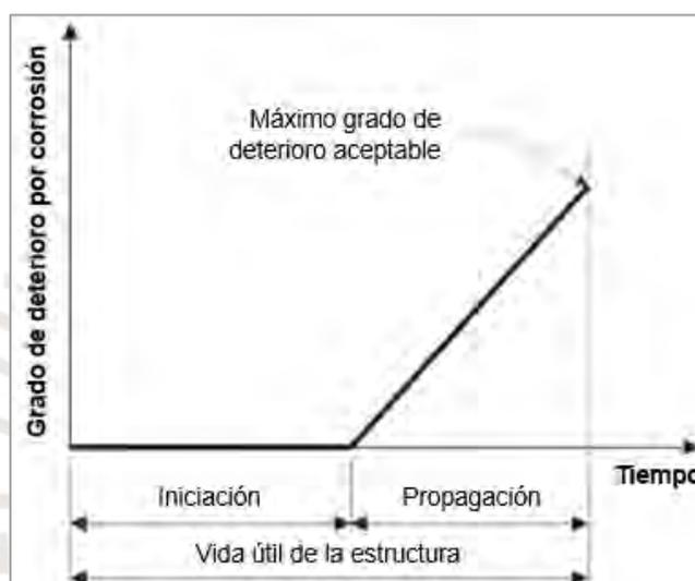
*Figura 8.* Iniciación y propagación de corrosión en una estructura – Modelo de Tuutti
