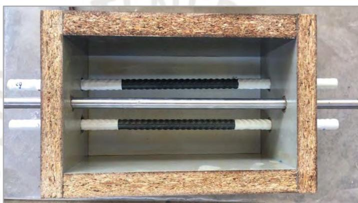
Figura 20. Vista en planta del encofrado con barras de acero dispuestas según el diseño
