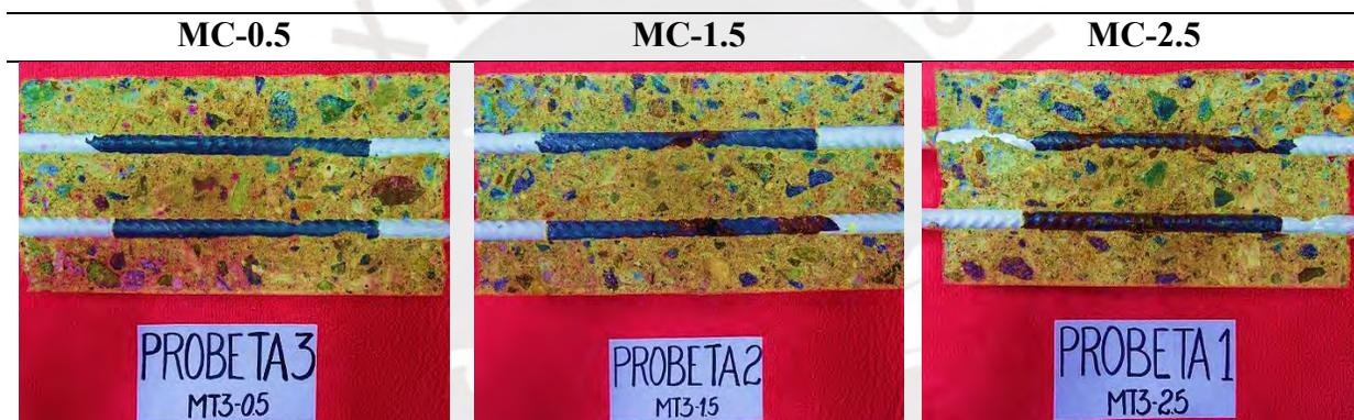
Figura 77. Comparación visual entre las mezclas MC en función al aumento de  $[NaCl]$
