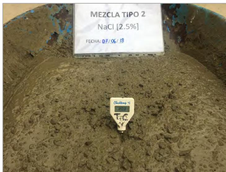
Figura 28. Medición de temperatura de la mezcla de concreto MB-2.5%,  $T = 20.3\text{ }^{\circ}\text{C}$
