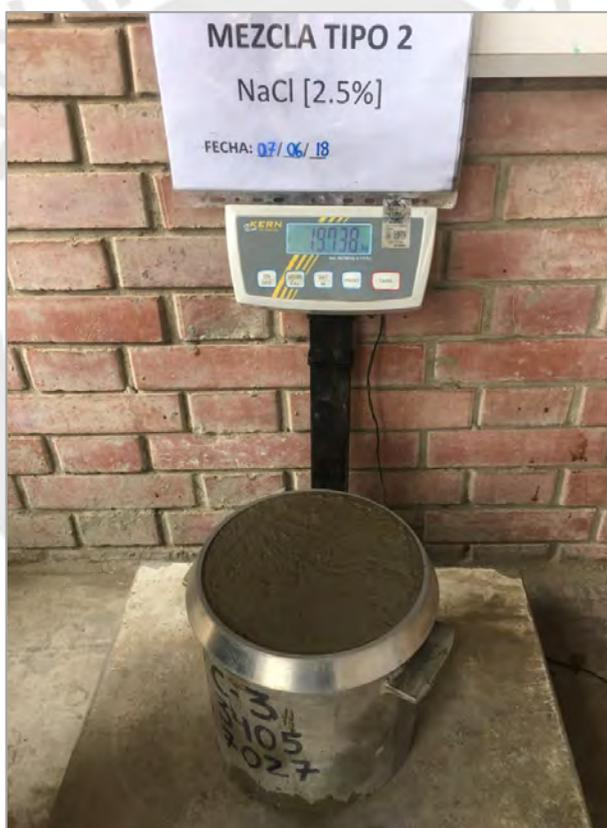
*Figura 30.* Ensayo de peso unitario de la mezcla MB-2.5%. P.U. = 2,324.32 kg/m<sup>3</sup>
