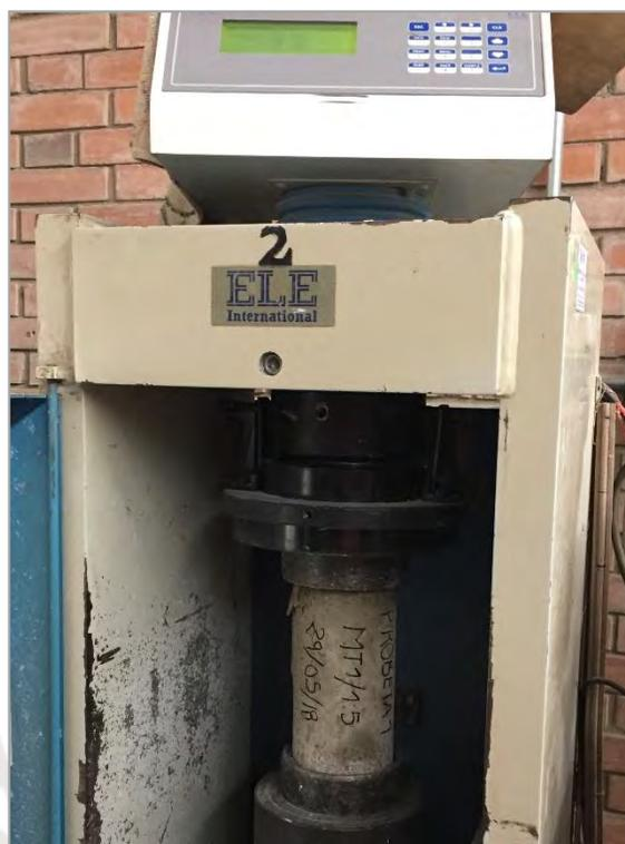
Figura 38. Ensayo de resistencia a compresión de probetas cilíndricas de concreto
