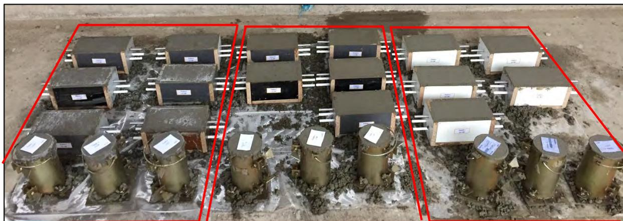
Figura 34. Moldeo de probetas prismáticas (05) y probetas cilíndricas (03) por cada mezcla
