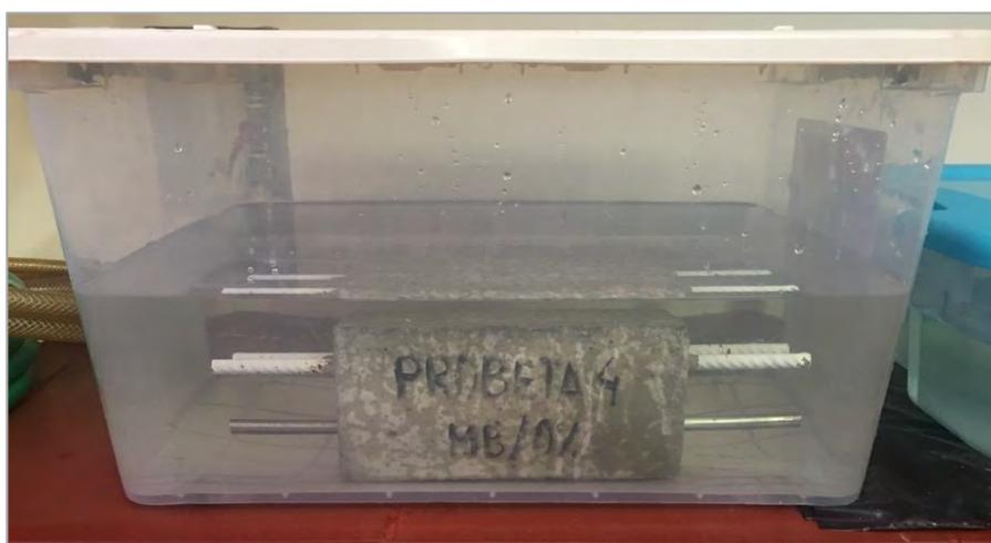
*Figura 43.* Saturación de 3 probetas prismáticas por cada tipo de mezcla de concreto.
