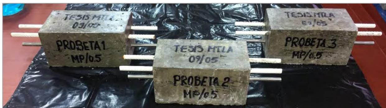
*Figura 44.* Secado de probetas prismáticas previo a las mediciones electroquímicas.
