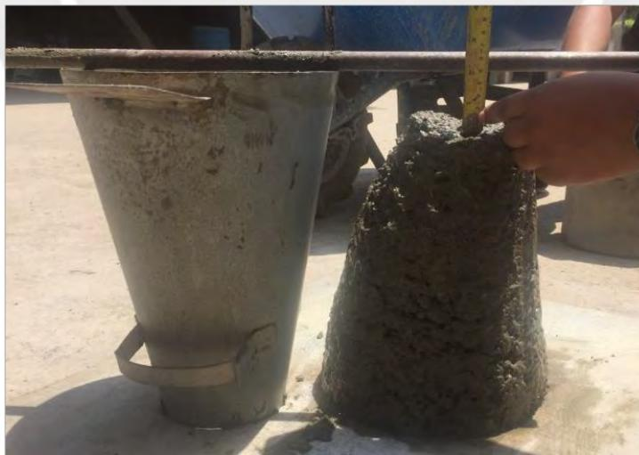
*Figura 23.* Mezcla prueba N° 1 (MB-2.5%), slump 5 cm, sin aditivo reductor de agua.
