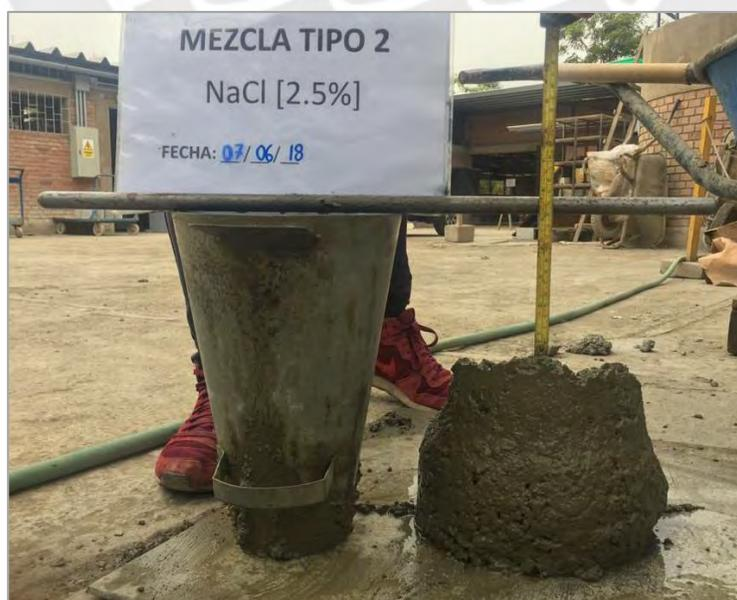
Figura 29. Asentamiento de la mezcla MB-2.5%, slump = 12.9 cm, falla tipo normal.
