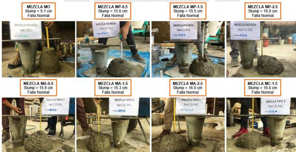
Figura 66. Evaluación del tipo de falla de las mezclas con slump fuera del límite especificado
