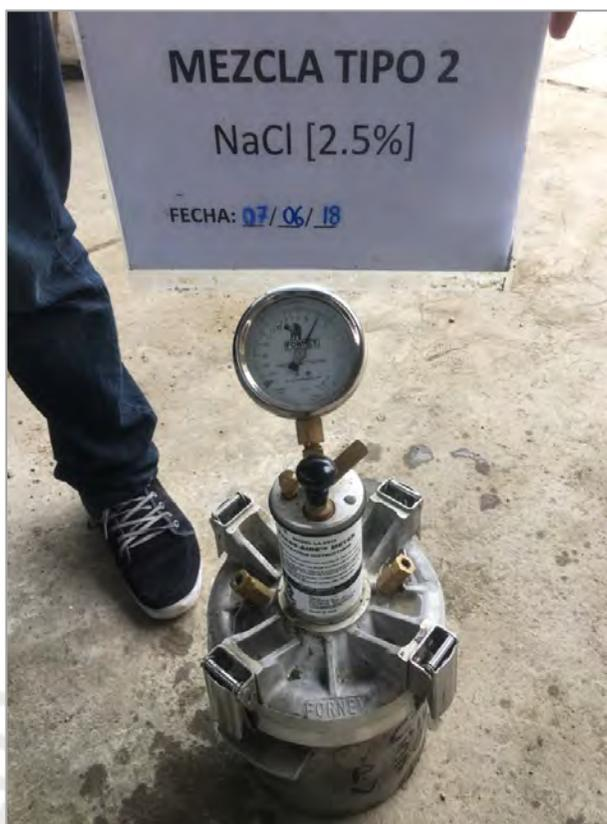
Figura 31. Ensayo de contenido de aire de la mezcla MB-2.5%, valor = 3.8%
