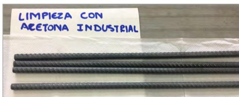
Figura 21. Barras de acero corrugado sin impurezas superficiales
