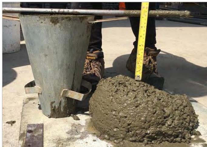
*Figura 24. Mezcla prueba N° 2 (MB-2.5%), slump 15 cm, con poca cohesión.*
