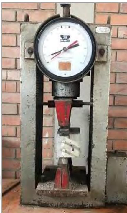
Figura 51. Equipo de ensayo de tracción diametral marca FORNEY
