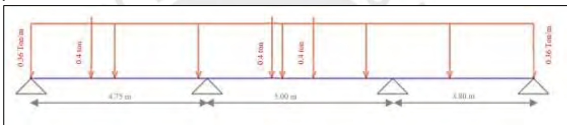
Figura 38: Modelo idealizado de la vigueta
