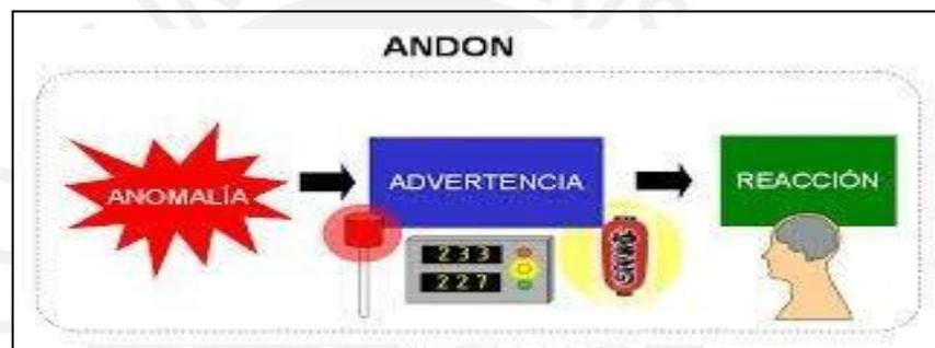
Figura 7: Esquema de comportamiento de sistema ANDON
