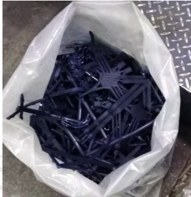
Gráfico 19: Rebabas de una estación de trabajo
