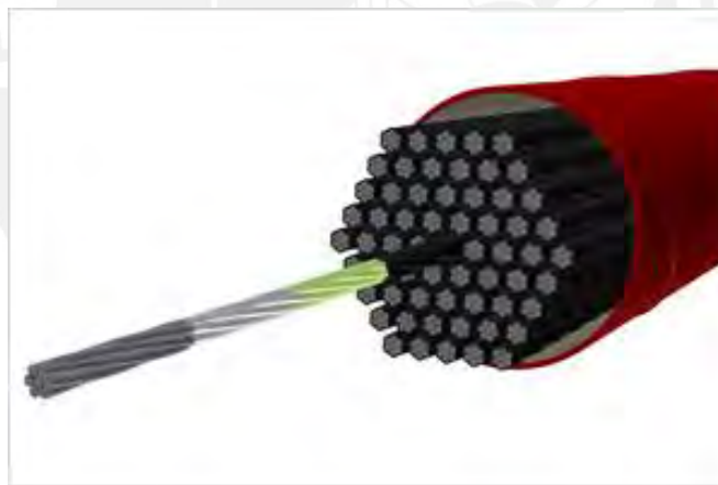
Figura 3.1.1-4: Cable con cordones paralelos ( http://www.kb-vt.com/index.php?id=299 )
