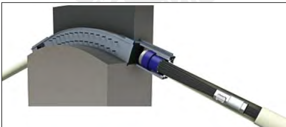
Figura 3.4-14: Anclaje con cajuela metálica de la marca DSI (DSI, 2016)
