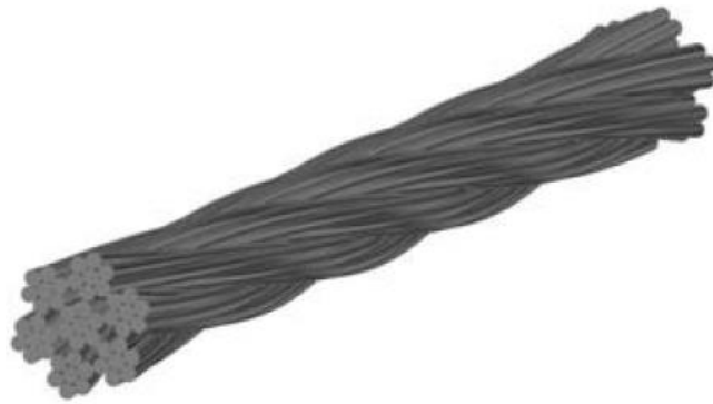
Figura 3.1.1-5: Arreglo tipo soga (Chatterjee, 2003).
