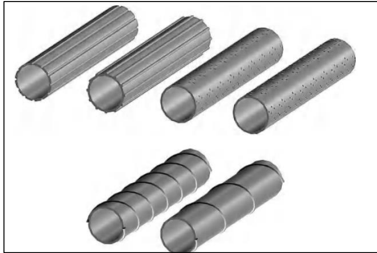
Figura 5.3.6-1: Superficies tratadas típicas. (Tomada de Gimsing y Georgakis, 2012).
