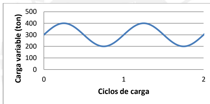
Figura 3.1.6-1: Ejemplo de carga sinusoidal de amplitud constante
