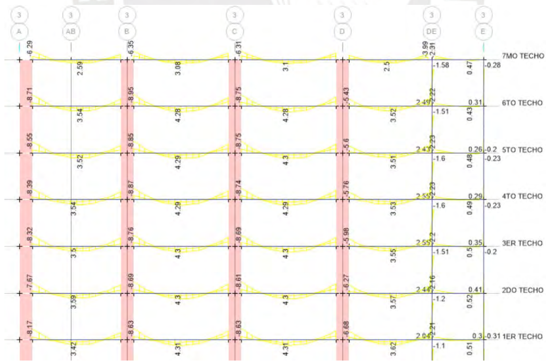
Figura 5.2. Envolvente de momentos en vigas eje 3-3. Sistema dual y diseño con acero Gr60.
