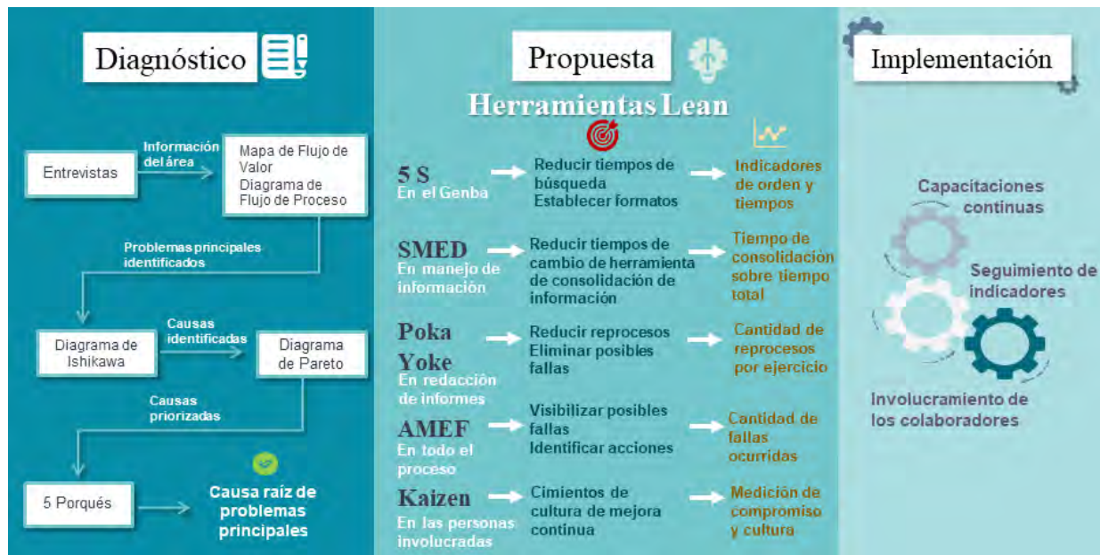
Figura 48. Metodología de autoría propia como propuesta para Lean Office en entidades públicas
