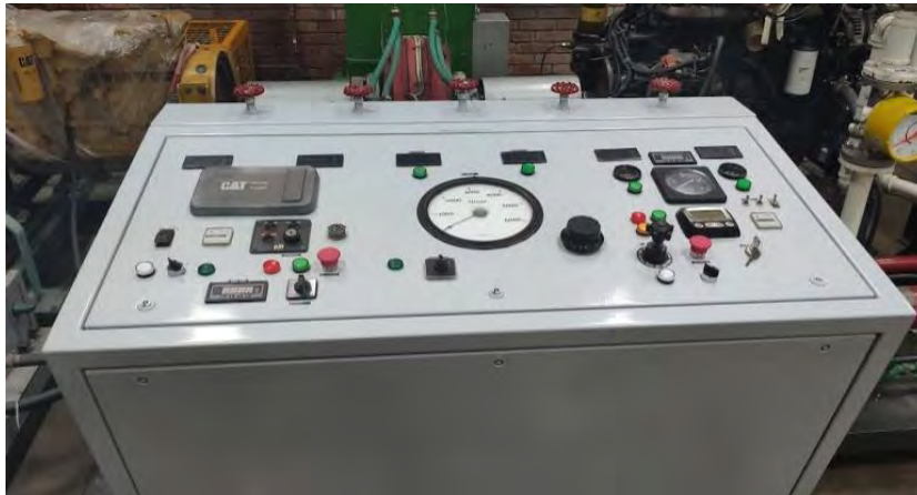
Figura 14 - Módulo de control del banco de pruebas.
