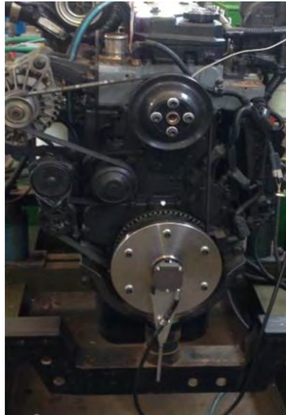
Figura 27 – Montaje del sensor de posición angular – 365C.
