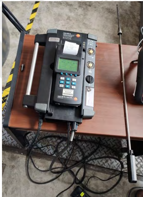
Figura 32 – Analizador de gases Testo.
