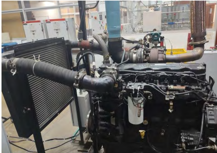
Figura 11 - Motor QSB 6.7 turboalimentado Cummins.
