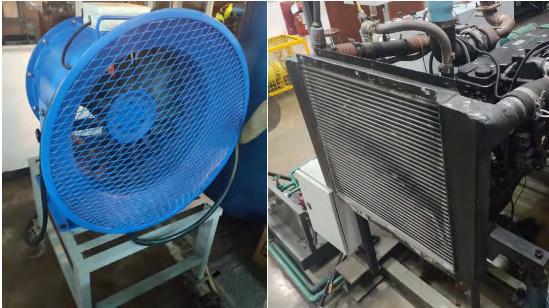
Figura 18 - Sistema de refrigeración del aire de admisión: a la izquierda se encuentra el ventilador axial y a la derecha, el intercooler .
