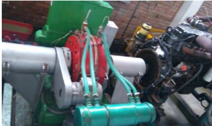
Figura 17 - Sistema de refrigeración del dinamómetro.
