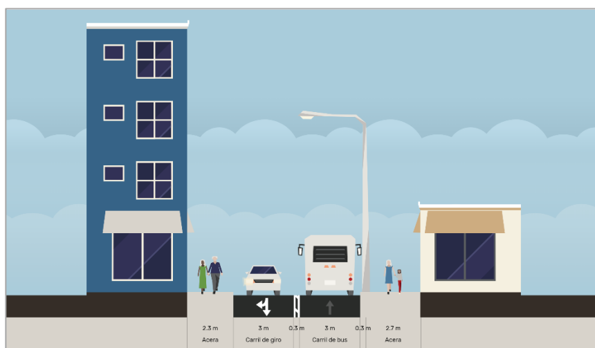
Figura 50. Sección vial propuesta Calle Granada. Fuente: propia.
