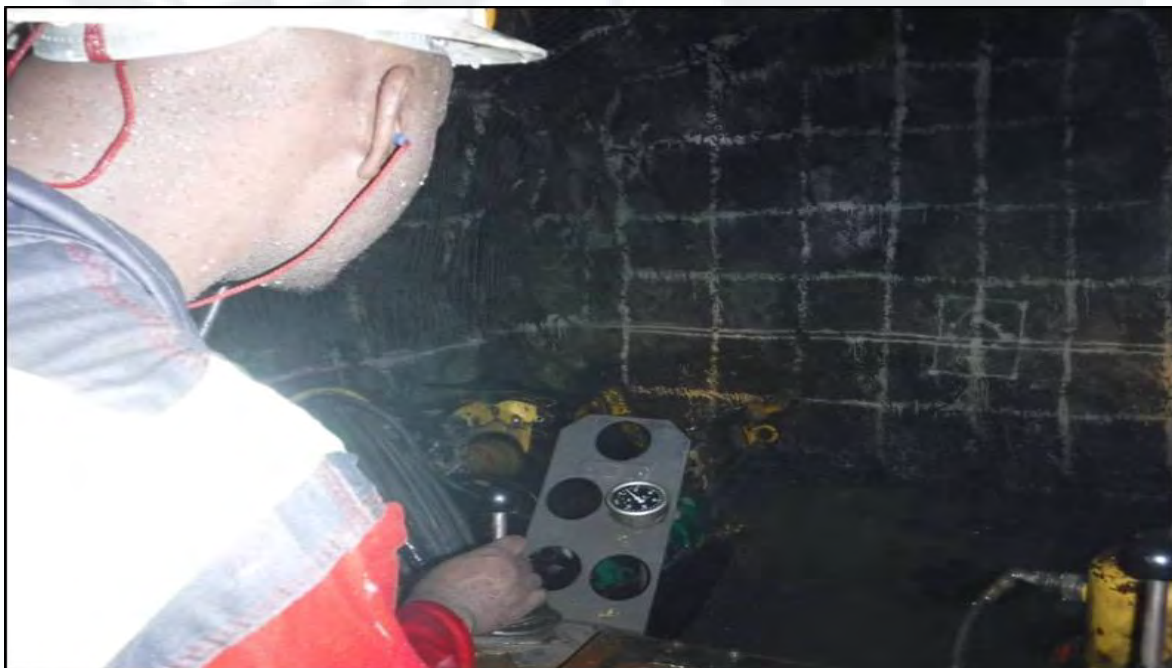
Figura 26. Foto de un operador de Reliant perforando con un equipo jumbo. Tomado de Revisiones Gerenciales de Reliant , por J. Huamaní, 2019, Kitwe, Zambia: Reliant.
