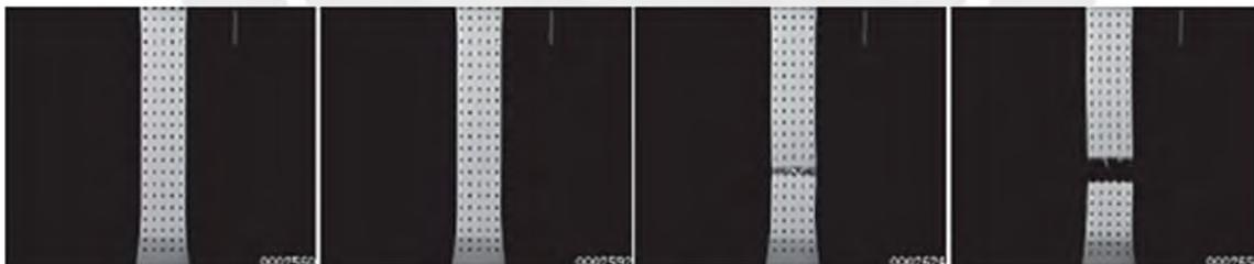
Figura 25. Ejemplo de comportamiento a tracción de una probeta de ABS. Fuente: <https://www.shimadzu.com/an/industry/petrochemicalchemical/n9j25k00000dmyx5.html>
