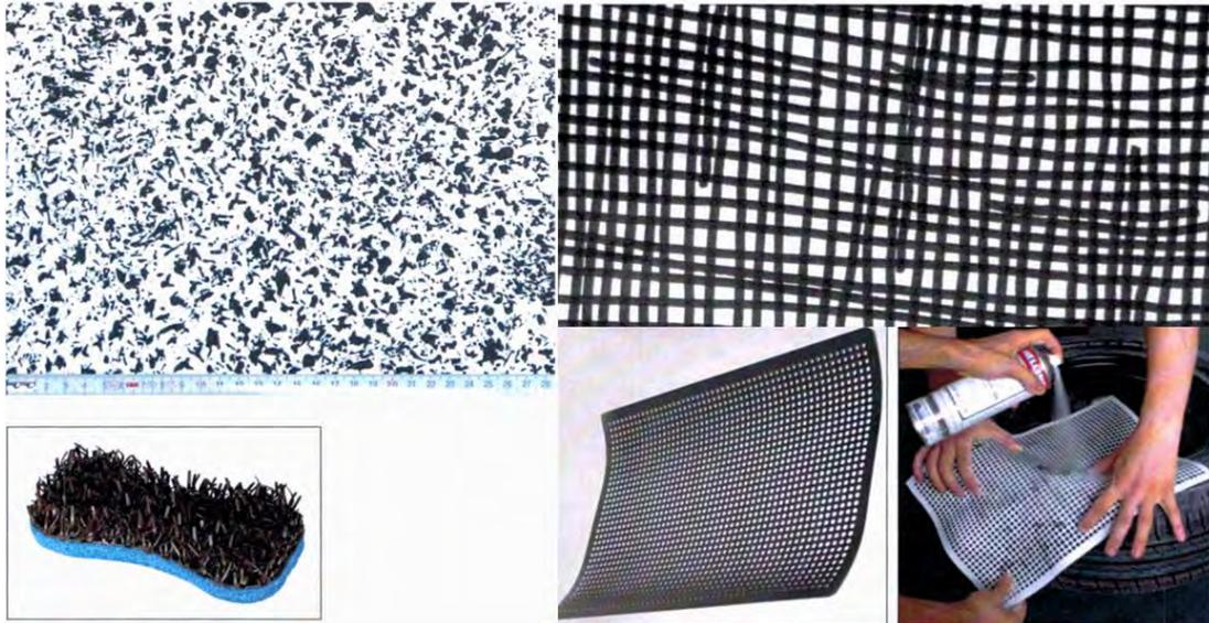
*Figura 18. Conjunto de técnicas para crear un patrón espectrométrico. Izquierda: Usando un cepillo impregnado de pintura. Superior derecha: Uso de un lápiz con trazo libre. Inferior derecha: uso de cinta para tapar la superficie para el posterior uso de pintura con atomizador sobre dicha superficie [12].*
