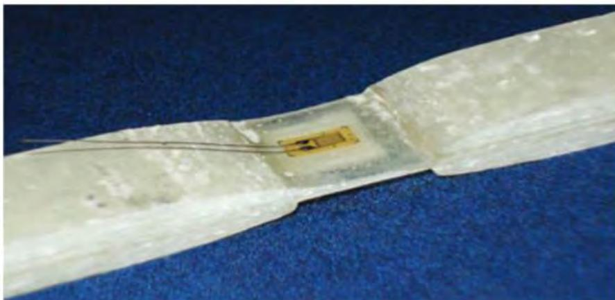
Figura 43. Probeta en el medio con dos pestañas de mayor espesor unidas a ella [33].
