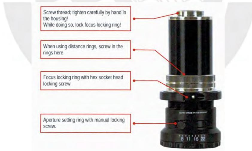
Figura 36. Lentes de distancia focal 100 mm. De arriba hacia abajo: 1) Rosca de atornillamiento para enroscarse en el alojamiento, 2) Anillos de distanciamiento que se atornillan en el aro plateado, 3) Anillo de bloqueo que se ajusta con la herramienta de tuerca hexagonal, 4) Ajuste de apertura con anillo de bloqueo manual. Fuente Manual GOM ARAMIS
