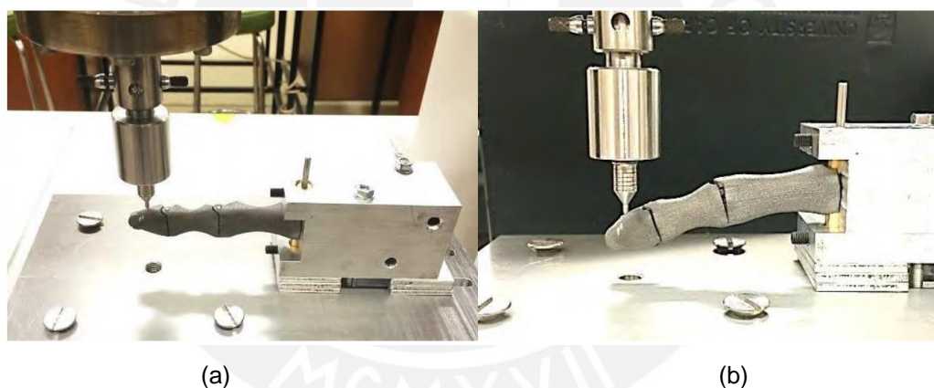
Figura 1.5. (a) Configuración de ensayo de flexión distal de dedos protésicos (b) Configuración de ensayo de flexión lateral sobre dedos protésicos (Tenim, 2014).
