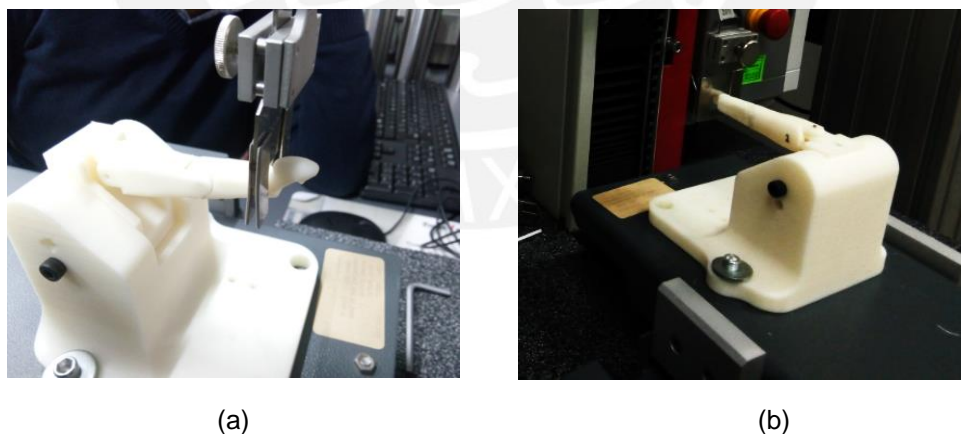
Figura 3.14. Montajes para Ensayos de Flexión: (a) Flexión en Hiperflexión de Dedo y (b) Flexión en Abducción de Dedo.
