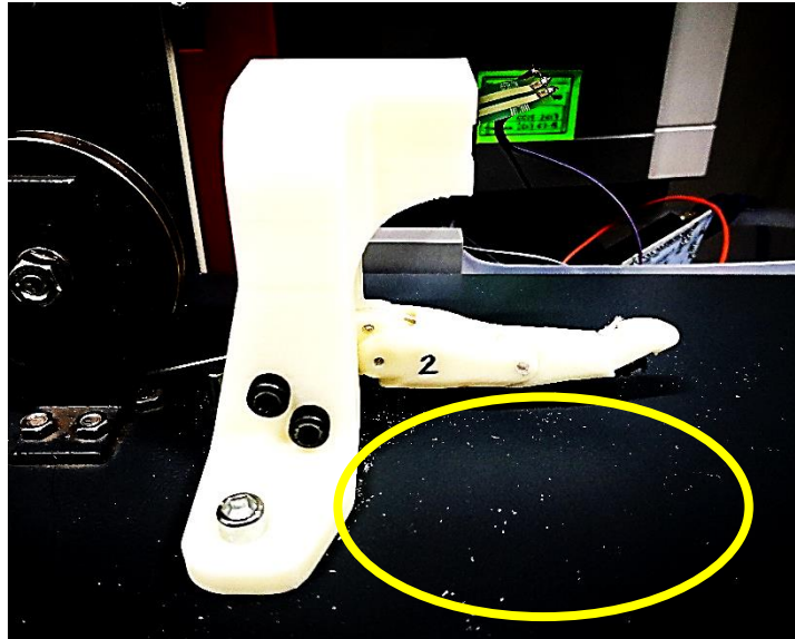
Figura 3.26. Partículas de ABS en la mesa utilizada para el ensayo de fatiga y desgaste de falange índice debido a la fricción entre el hilo y los canales al interior del dedo.
