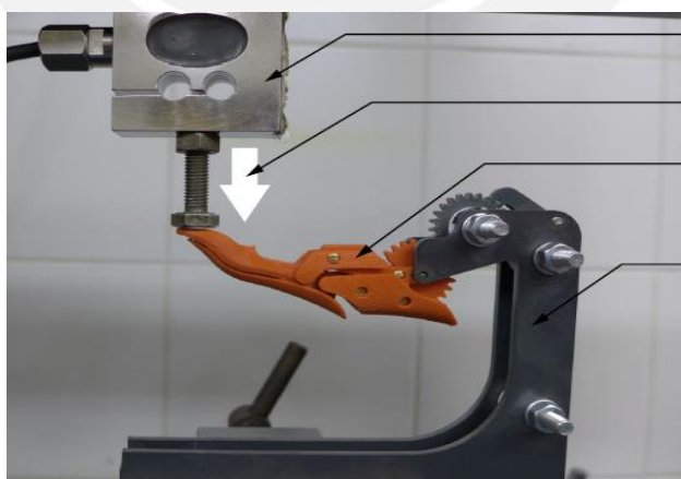
Figura 1.4. Configuración para el ensayo de flexión distal de dedos (J. Koprnicky et al., 2018).
