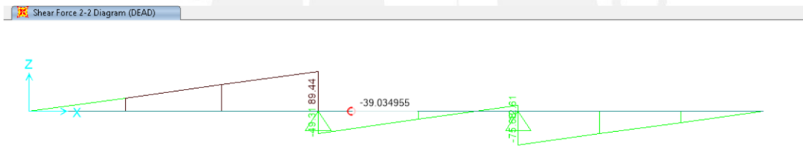
Figura 82: Diagrama de fuerza cortante de la viga.
