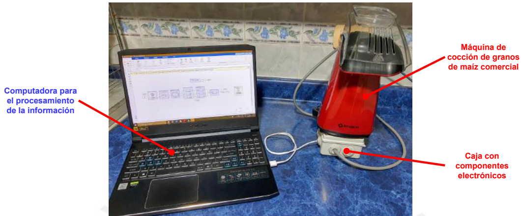
Figura 4.10: Entorno de operación del prototipo. Fuente: Elaboración propia.
