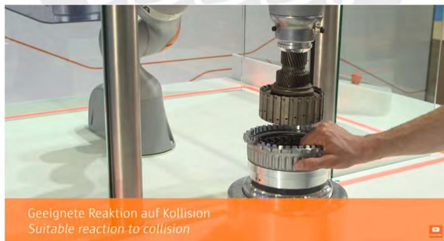
Figura 5. Fotograma en el cual se aprecia como el LBR iiwa reacciona cuando detecta una posible colisión.
