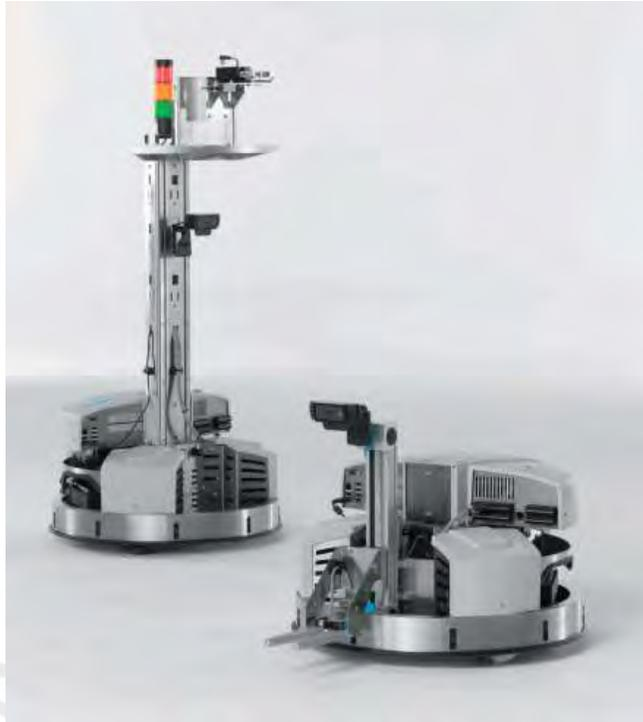
*Figura 1. Versiones del Robotino: Premium (izquierda) y Basic (derecha).*
