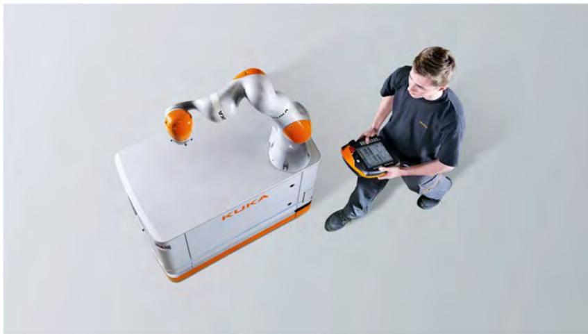
*Figura 6.* En esta imagen se aprecia como un KMR es controlado vía mando por un usuario.
