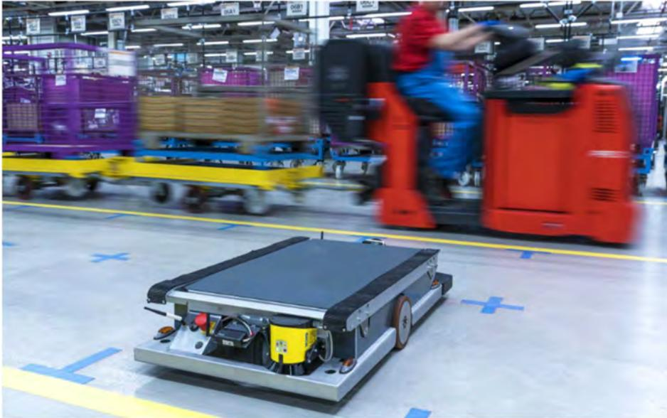
*Figura 7. Imagen de un robot BMW. Este esta imagen se lo muestra sin carga y detenido después de detectar un obstáculo en su ruta.*
