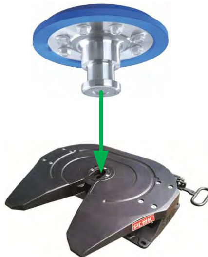
Figura 2-1 Perno rey y quinta rueda (Imagen real)
