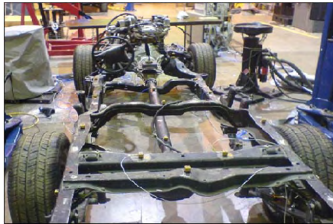
Figura 1-7 Chasis con sensores instalados
