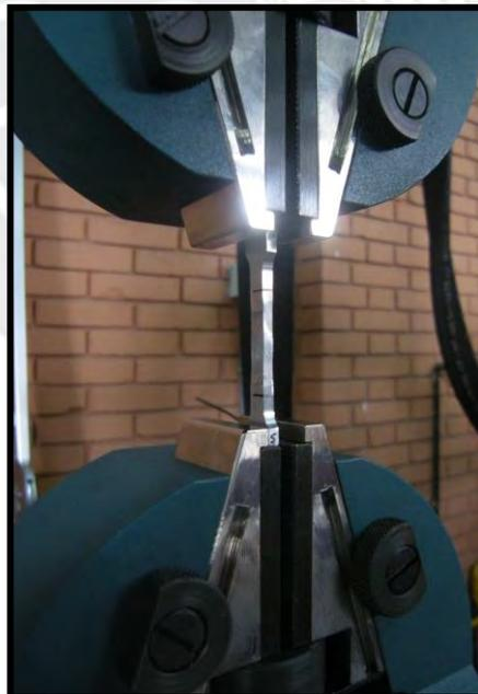
*Figura 2.14 Equipo empleado para el ensayo de tracción.*
