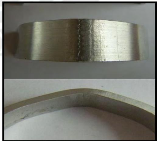
(f) Doblado raíz probeta 200 mm/min.
