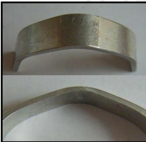
(c) Doblado cara probeta 140 mm/min.
