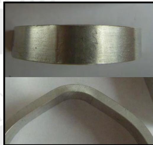
(d) Doblado raíz probeta 140 mm/min.
