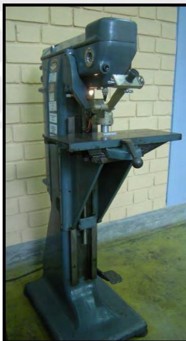
*Figura 2.15 Equipo empleado para el ensayo de dureza.*
