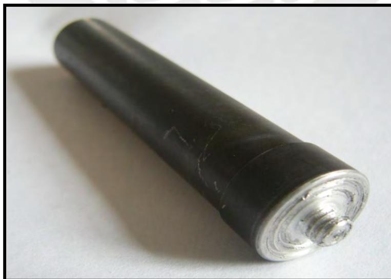
**Figura 3.1** Herramienta después de realizada la soldadura por fricción batido.
