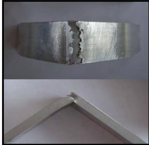
(b) Doblado raíz probeta 60 mm/min.
