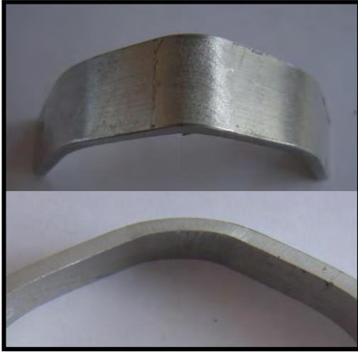
(a) Doblado cara probeta 60 mm/min.
