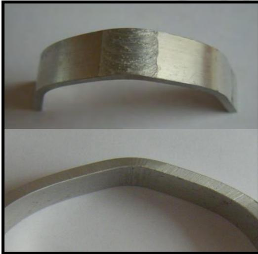
(c) Doblado cara probeta 140 mm/min.
