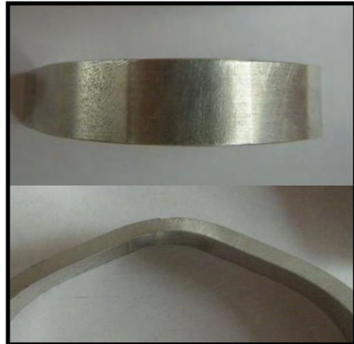
(b) Doblado raíz probeta 60 mm/min.
