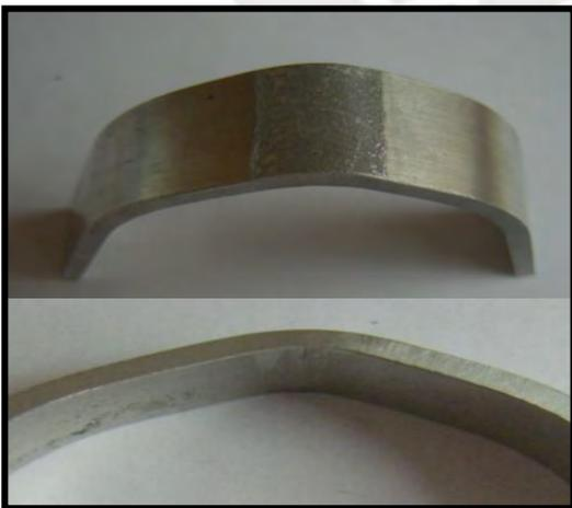
(e) Doblado cara probeta 200 mm/min.
