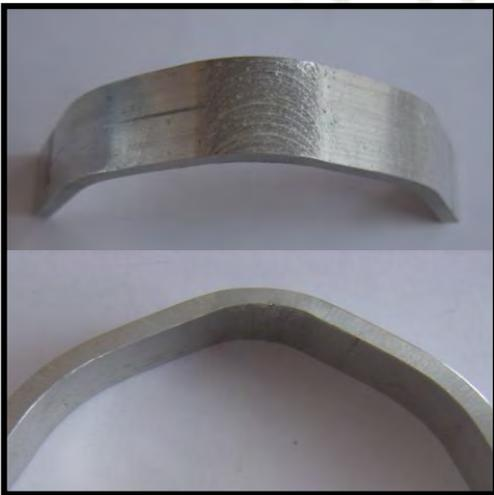
(c) Doblado cara probeta 140 mm/min.
