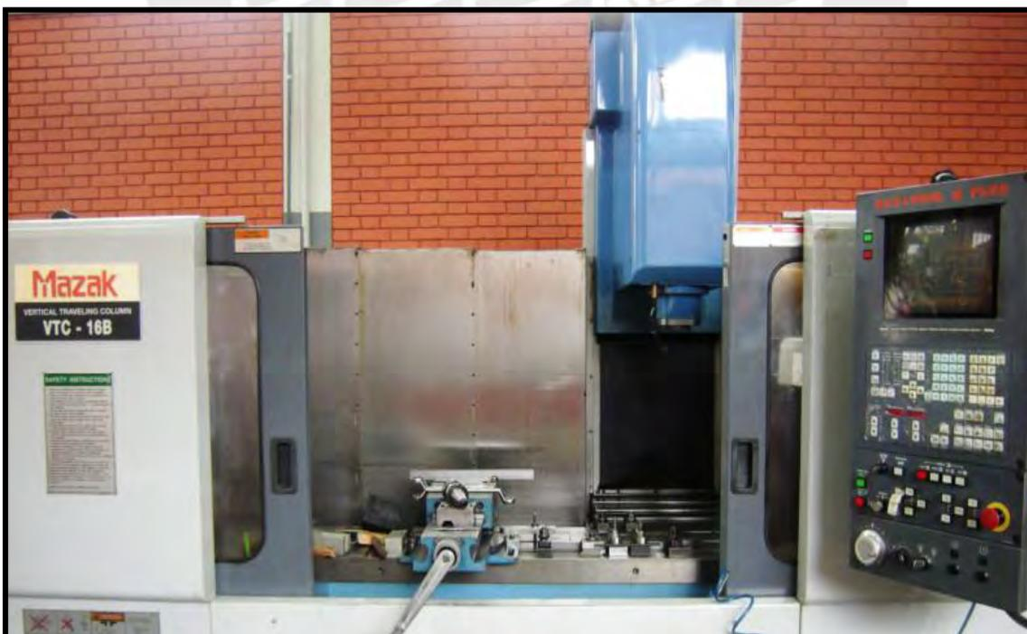
**Figura 2.1** Fresadora de Control Numérico Computarizado del Laboratorio de Manufactura de la Sección de Ingeniería Mecánica.
