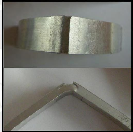
(d) Doblado raíz probeta 140 mm/min.
