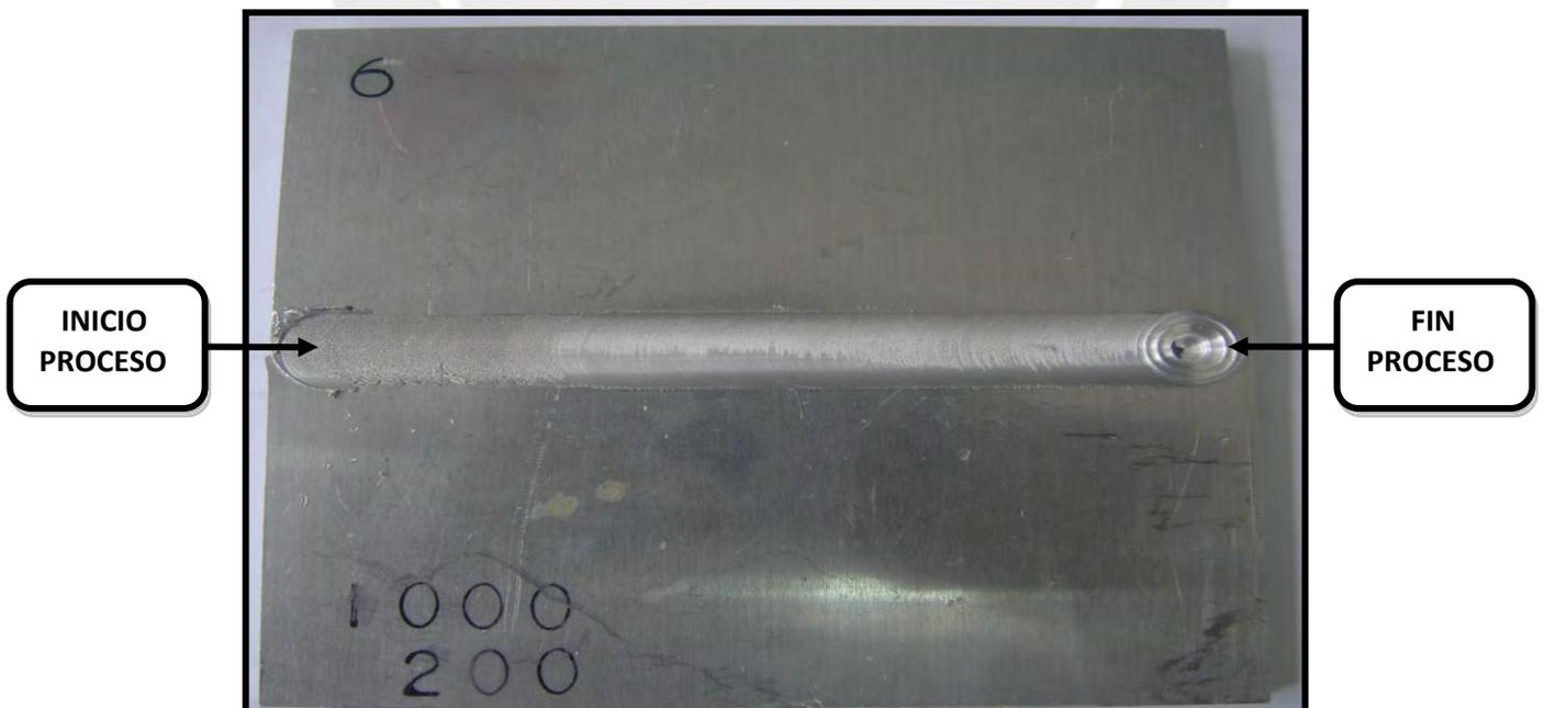
*Figura 2.11. Plancha de aluminio AA1100-H18 soldada por fricción batido.*
