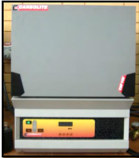
**Figura 2.4** Horno de Calcinación CARBOLITE 1100.
