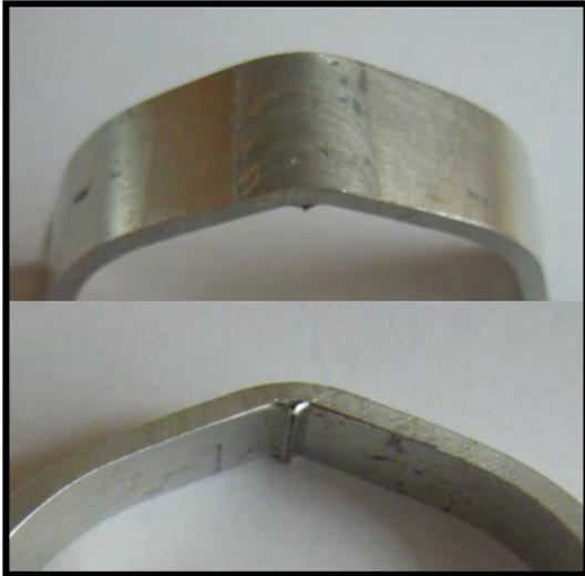
(a) Doblado cara probeta 60 mm/min.
