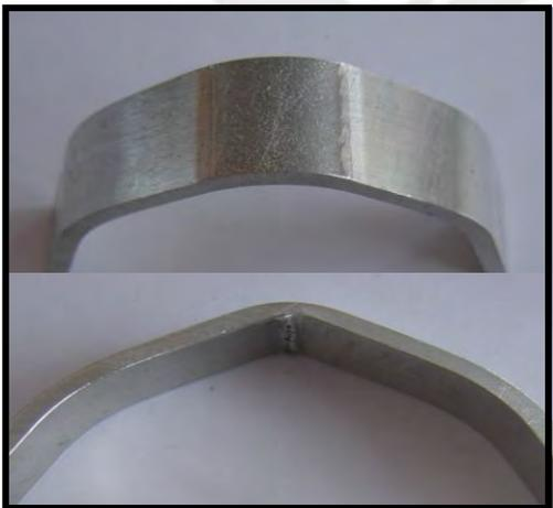
(e) Doblado cara probeta 200 mm/min.
