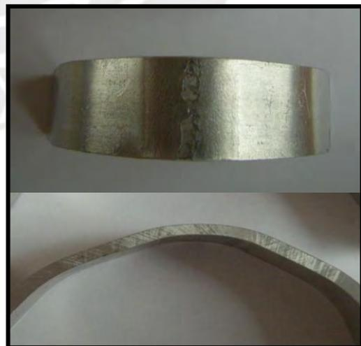
(f) Doblado raíz probeta 200 mm/min.
