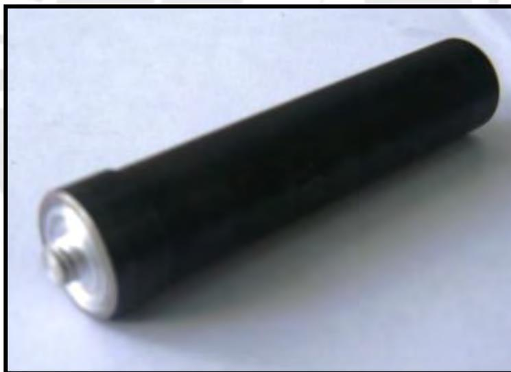
**Figura 2.6** Herramienta después del revenido.
