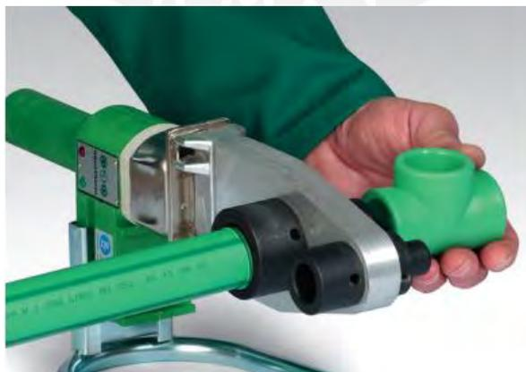
**Figura 4.** Unión por termofusión de tubo y accesorio
