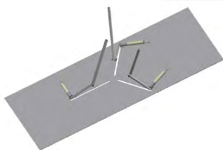
(a) Plataforma con motores y sus mecanismos de biela-manivela
