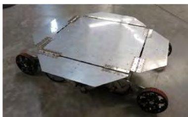
(a) Configuración extendida de la superficie de aterrizaje
