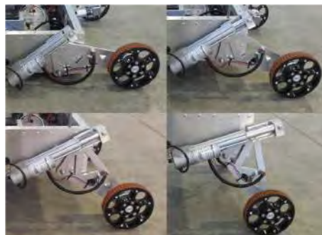
(c) Mecanismo de actuador lineal de la plataforma de aterrizaje
