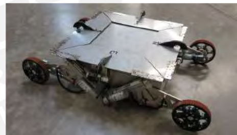
(b) Configuración doblada de la superficie de aterrizaje
