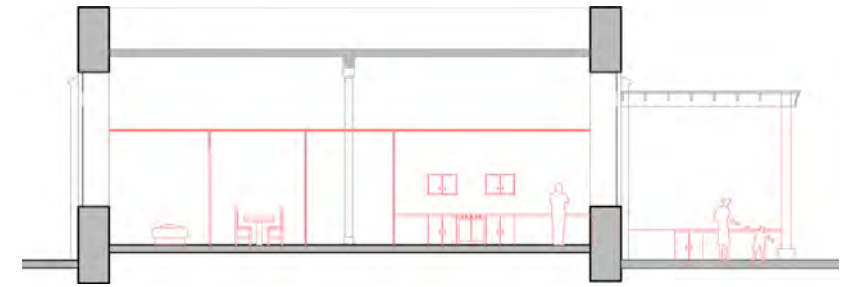
2020 ADAPTACIÓN A VIVIENDAS CON TECHO REDUCIDO CERRAMIENTO DEL PARASOL
