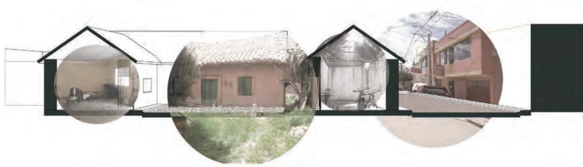
En la tercera etapa se establece como postura de intervención la rehabilitación que se basa modificar para mantener un espacio adecuado, para esto es necesario retirar construcciones cuyo sistema constructivo tengan materiales no compatibles con la técnica constructiva de tierra existente. Para esta etapa se decide manejar un catálogo de rehabilitación que abarquen lineamientos del mejoramiento estructural, confort y mantenimiento de fachada.
