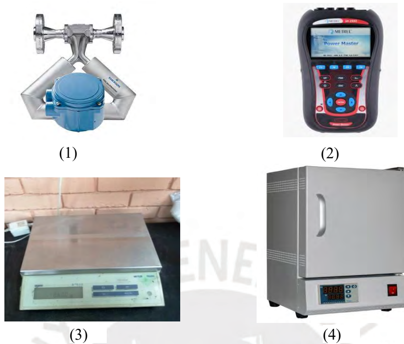
Figura 3.11.- Instrumentación: (1) sensor de flujo másico y transmisor Emerson Micro Motion; (2) analizador de Redes Metrel; (3) balanza electrónica marca Mettler Toledo; (4) horno Gallenkamp.
