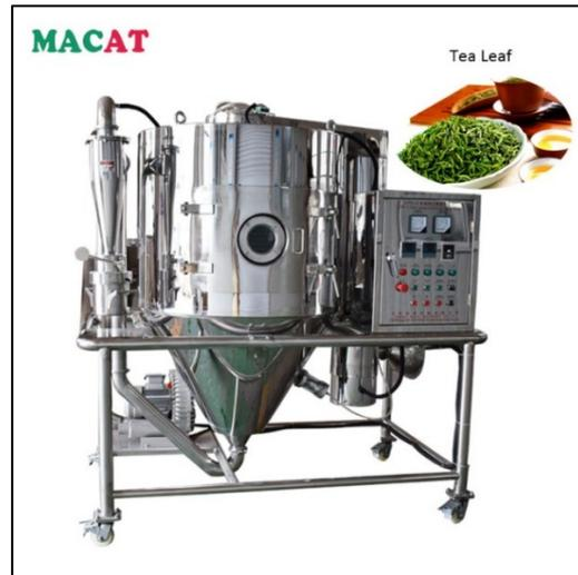
Figura 36: Secador de pulverización centrífuga
