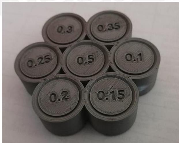
Figura 3.5 Elemento 3D impreso a base de plástico PET para determinar ajuste y juego a diferentes niveles de tolerancia
