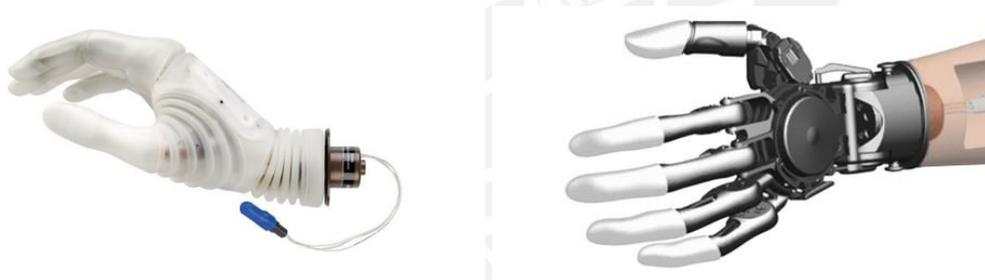
Figura 1.15 Prótesis comercial de mano Michelangelo con el Sistema Protésico Axon-Bus
