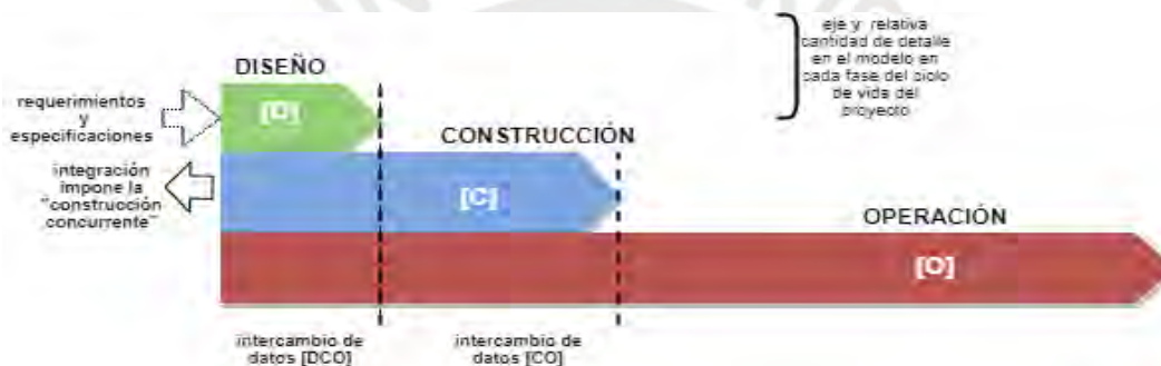
Figura 13. Fases del ciclo de vida de un proyecto durante la etapa BIM 3. Extraído de “Building information modelling framework: A research and delivery foundation for industry stakeholders”, por Succar, B., 2009.
