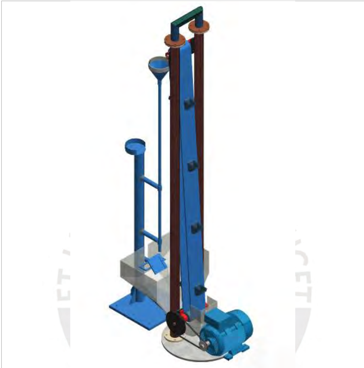
Figura 7.- Esquema de la máquina de prueba erosiva de fabricación propia basada en ASTM D-968
