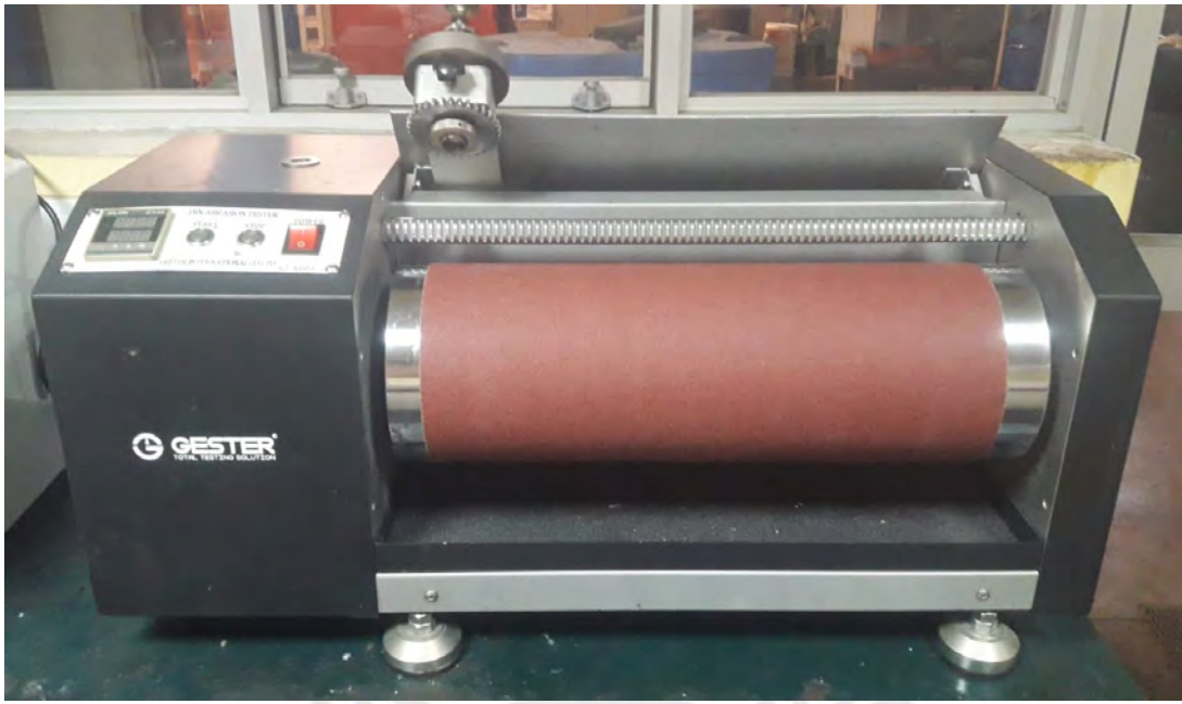
Figura 6.- Abrasímetro de rodillo cilíndrico giratorio
