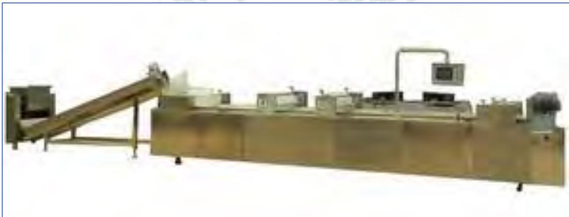
Figura 14: Máquina laminadora y cortadora de barras.
