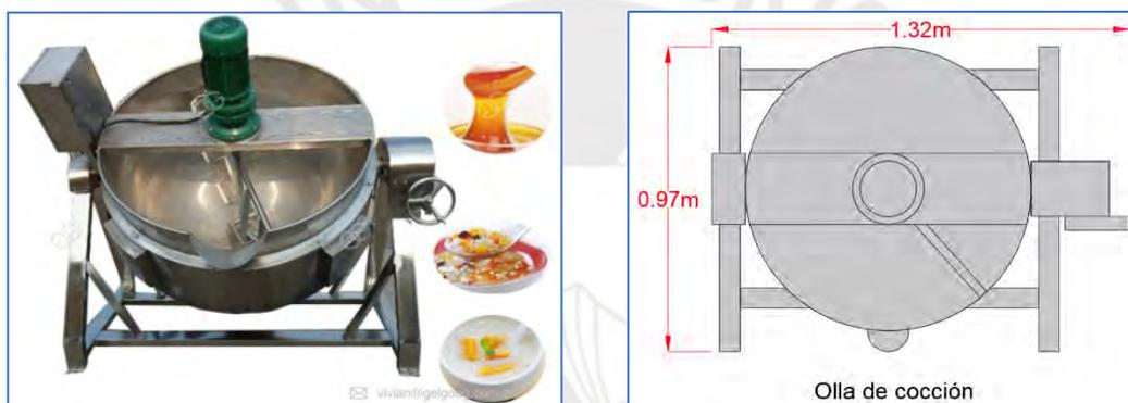
Figura 27: Olla de cocción para azúcar.
