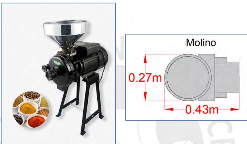
Figura 25: Molino de granos duros y esquema en planta.
