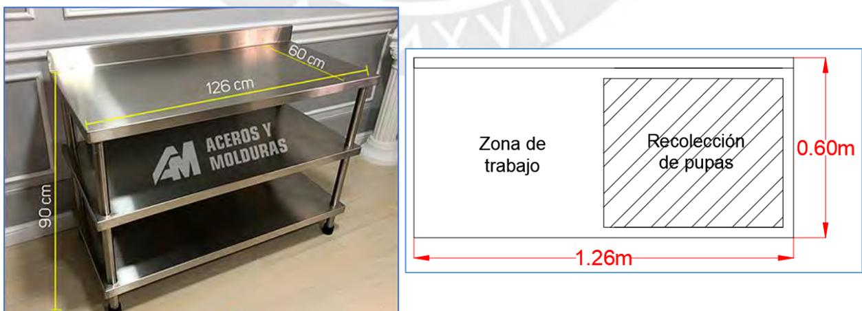
Figura 22: Mesa de acero inoxidable y esquema en planta.
