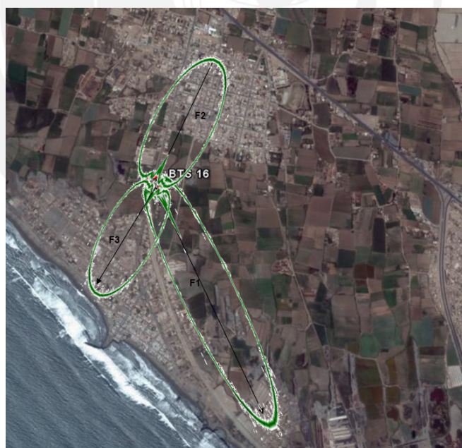
Figura 4.9 Cobertura en la fase 3 – Segunda Parte
