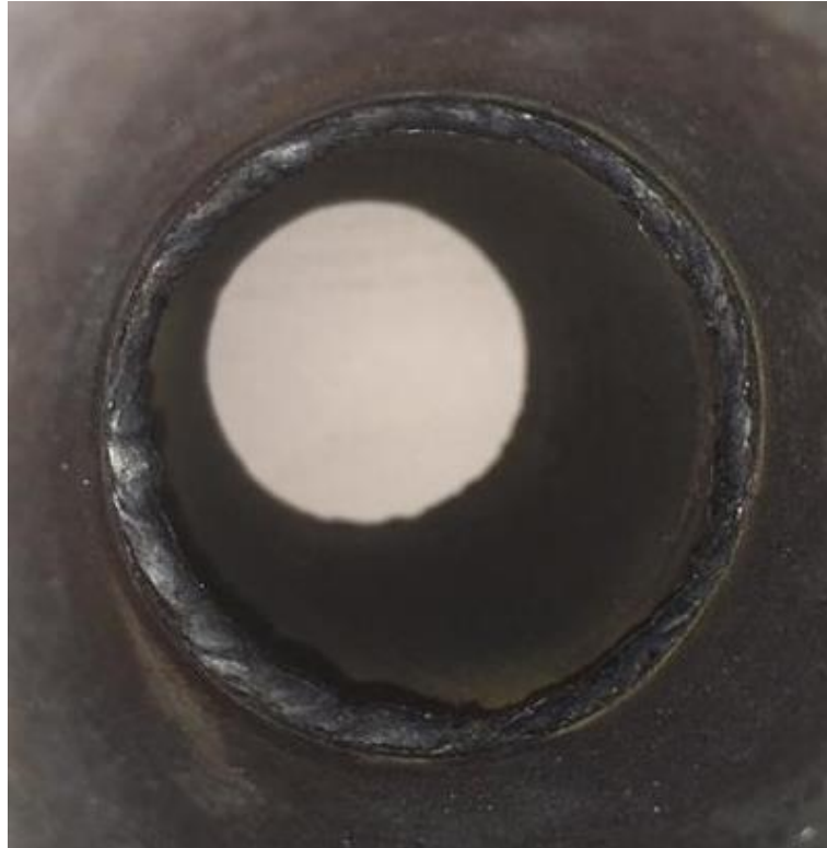
Figura 3.18 Revisión de los cordones de raíz
