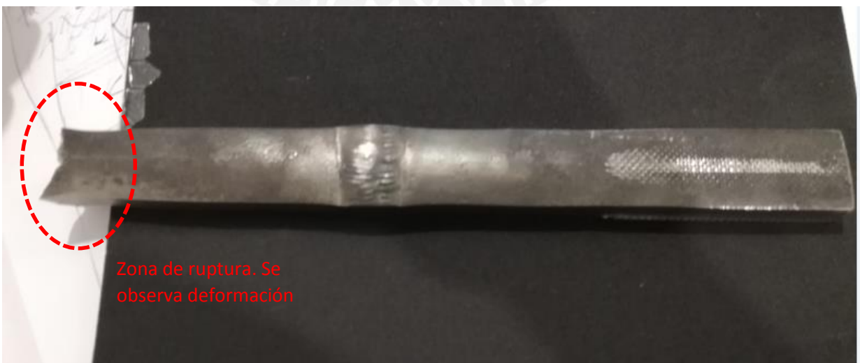
Figura 3.3 Probeta de tracción rota
