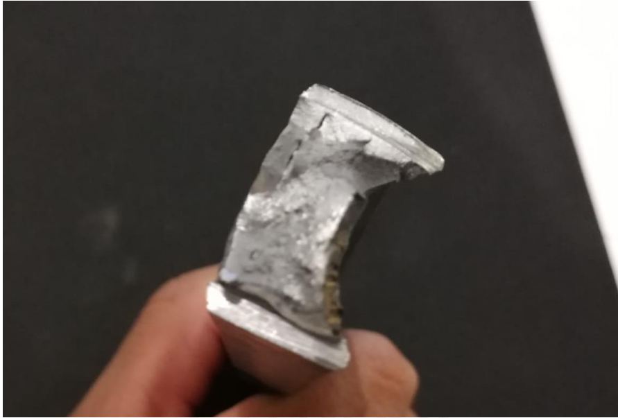
Figura 3.10. Ensayo Nick Break, zona interna primera mitad
