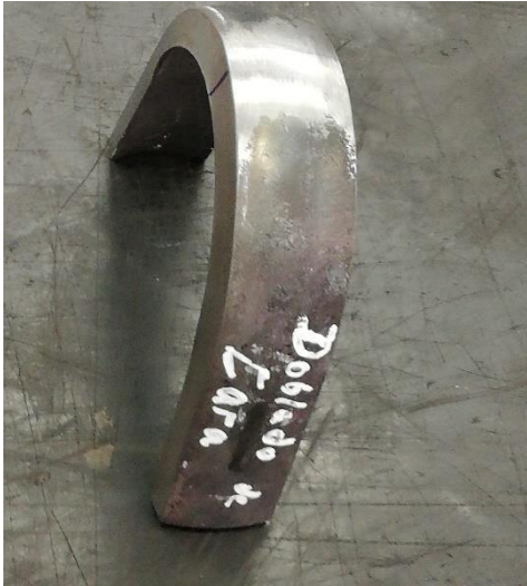
Figura 3.6. Resultado doblado de cara
