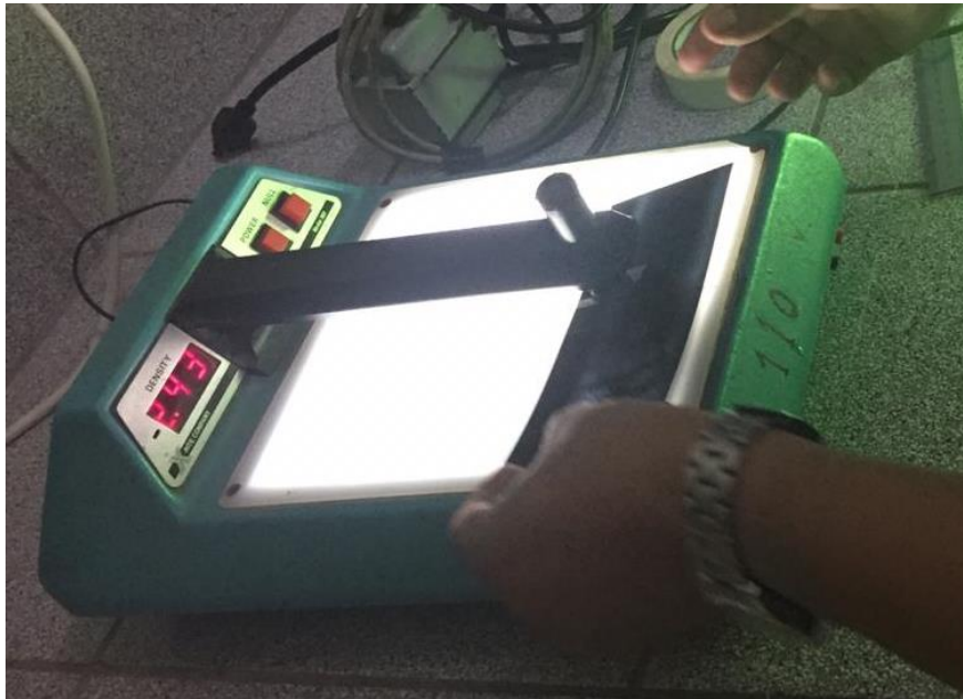
Figura 3.21 Comprobación de las densidades de la película.
