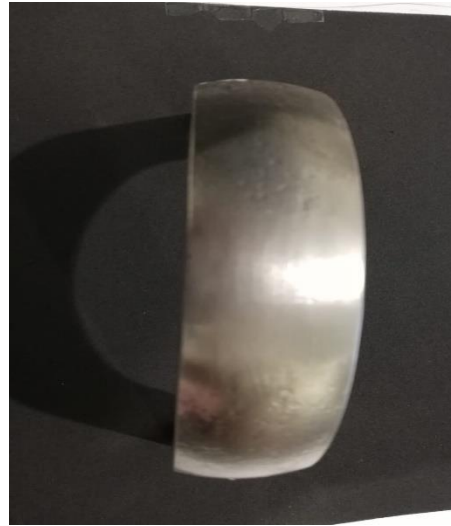
Figura 3.6. Resultado doblado de cara
