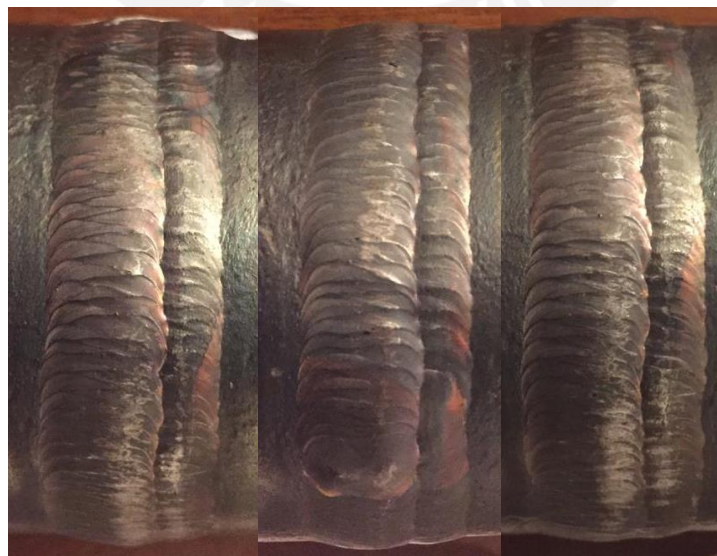
Figura 3.17 Revisión de los cordones de cara
