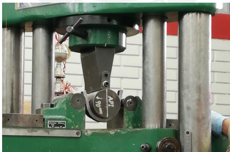
Figura 3.5. Proceso de doblado
