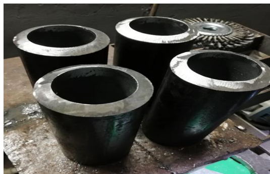
Figura 2.13 Preparación de cupones
