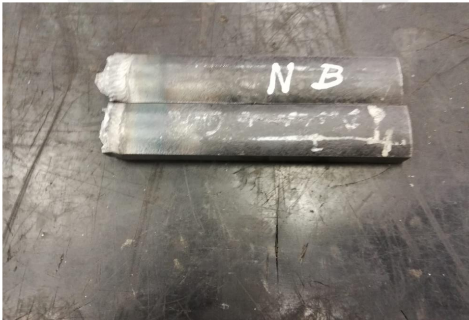
Figura 3.9. Probeta rota, Nick Break
