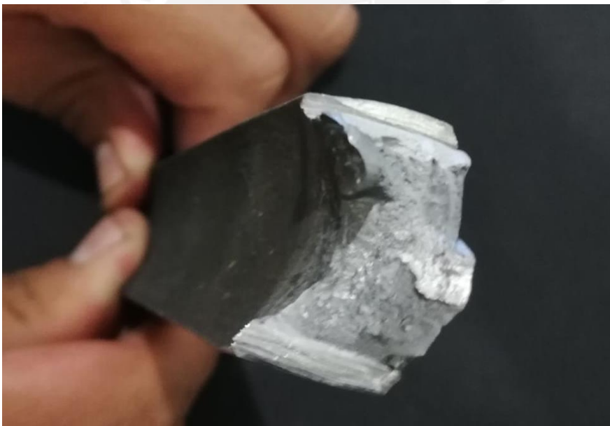
Figura 3.11. Ensayo Nick Break, zona interna segunda mitad
