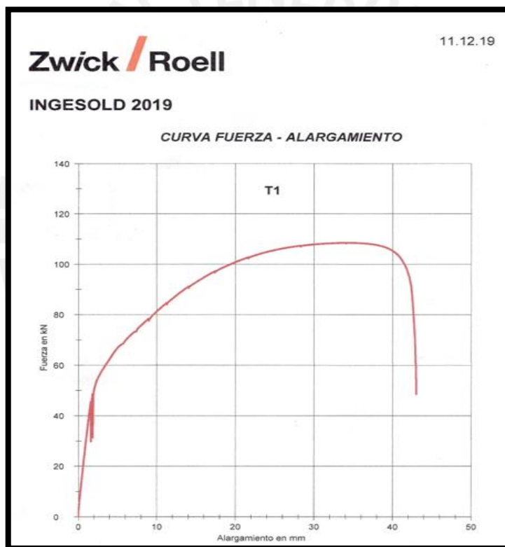
Figura 3.1 Curva Fuerza vs Alargamiento
