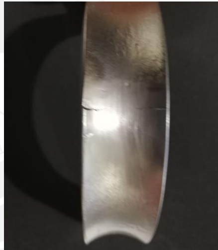
Figura 3.7. Resultado doblado de raíz
