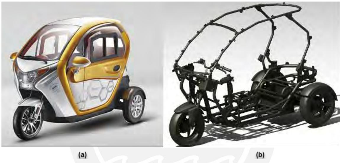
Figura 2.15: (a) Trimoto eléctrica E1 3.0 de Smart Cargo, (b) Chasis de la trimoto con el motor en la parte posterior.
