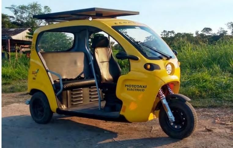
Figura 2.13: Trimoto eléctrica de la marca Ecoenergy en la zona amazónica
