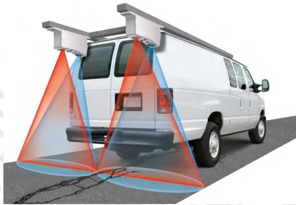
Figura 8. Detección de fallas: Tecnología Láser 3D
