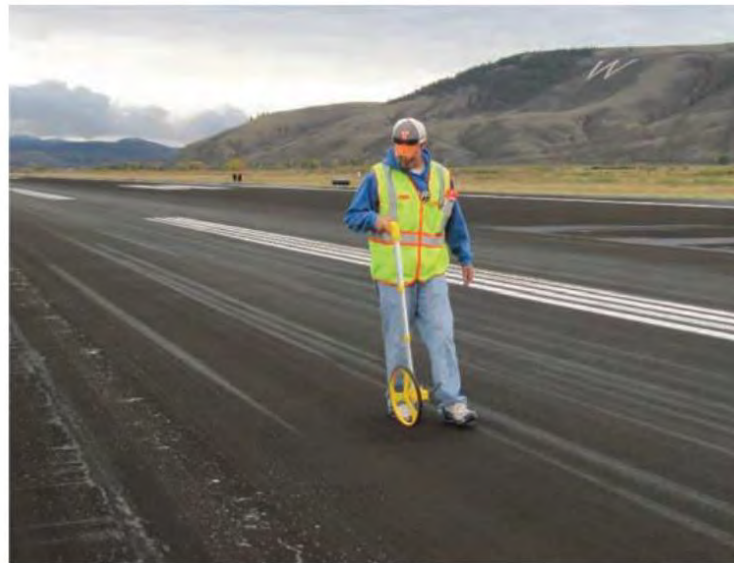
Figura 5. Inspección Visual en Campo: Analista con odómetro
