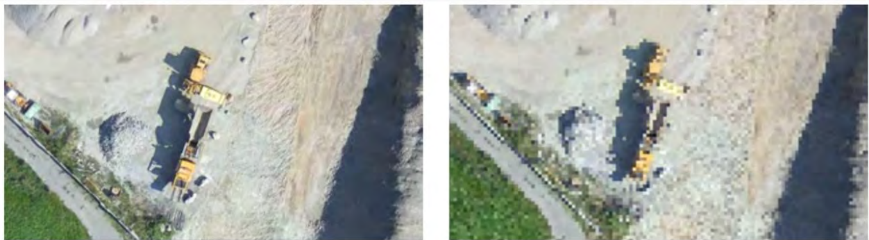
Figura 23. Ejemplo de exactitud determinado por el Ground Sampling Distance
