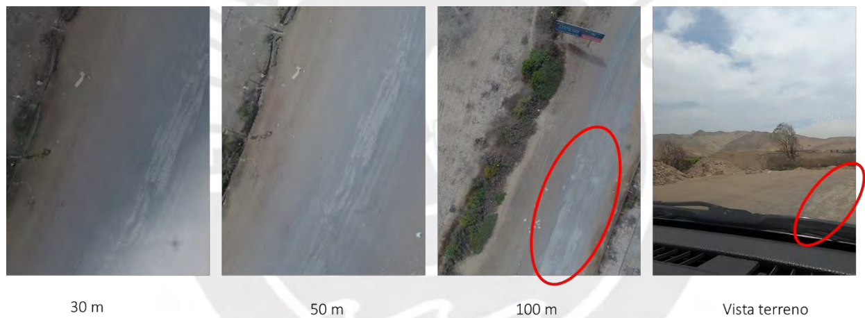
Figura 25. Ensayo de campo con dron DJI M210 V2 RTK
