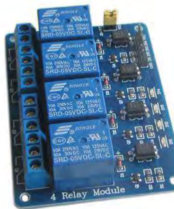
Figura 85 Módulo de 4 relés SRD-05VDC-SL-C.
