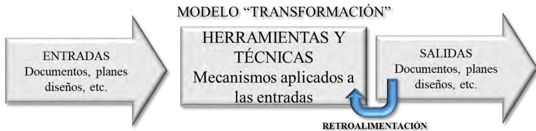
Ilustración 4. Esquema descriptivo de un proceso más retroalimentación (feedback) (Adaptado de la guía de fundamentos del PMBOK 6ta Edición, 2017)
