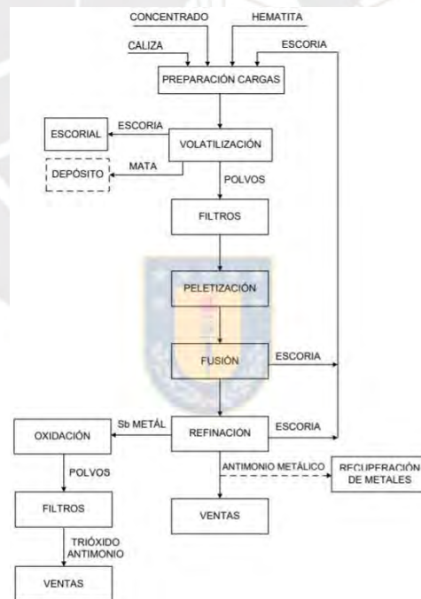
Figura 2. Diagrama de flujos de producción de antimonio metálico y trióxido de antimonio.
