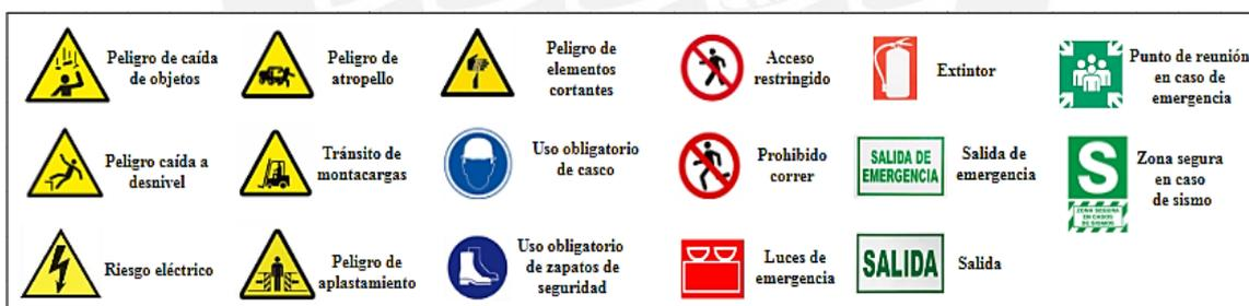
Figura 56: Simbología de uso general en el almacén (peligros, riesgos y elementos de seguridad)
