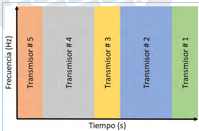
Figura 17: Descripción gráfica de TDMA [elaboración propia]
