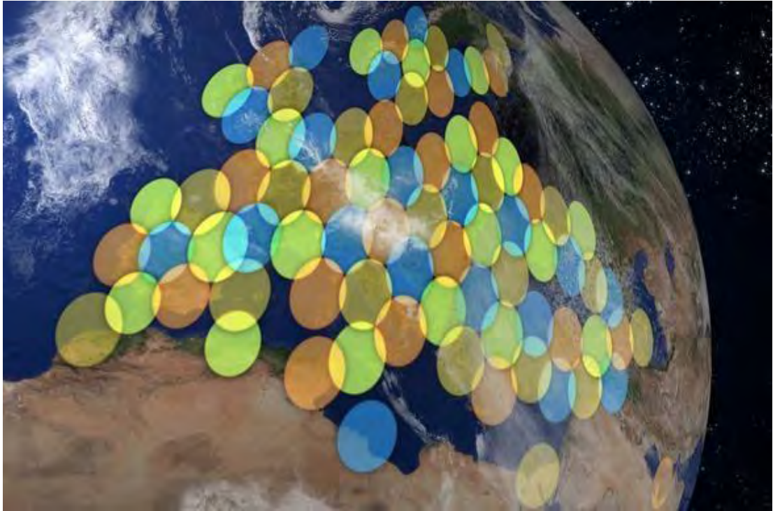
Figura 12: Área de cobertura de un satélite HTS [40]
