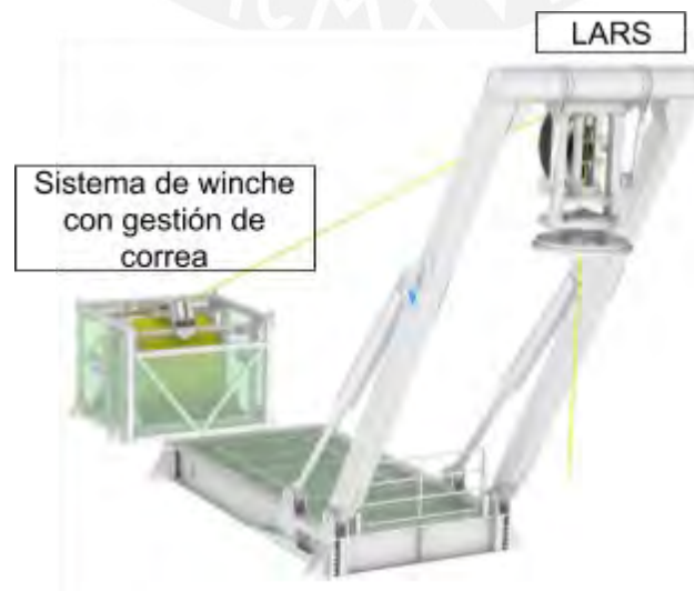
Figura 1.1: LARS con sistema de gestión de correa. (DECK Marine Systems, s.f). Adaptado
