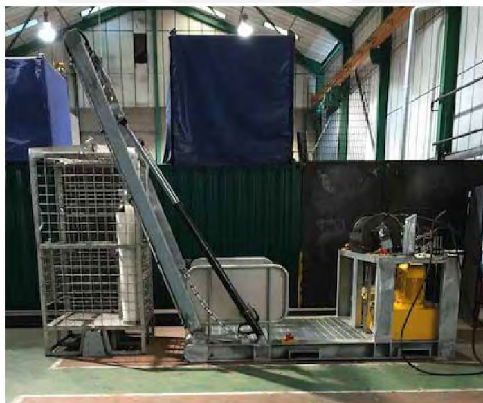
Figura 2.2: LARS tipo A-frame. (Northern Diver, s.f)
