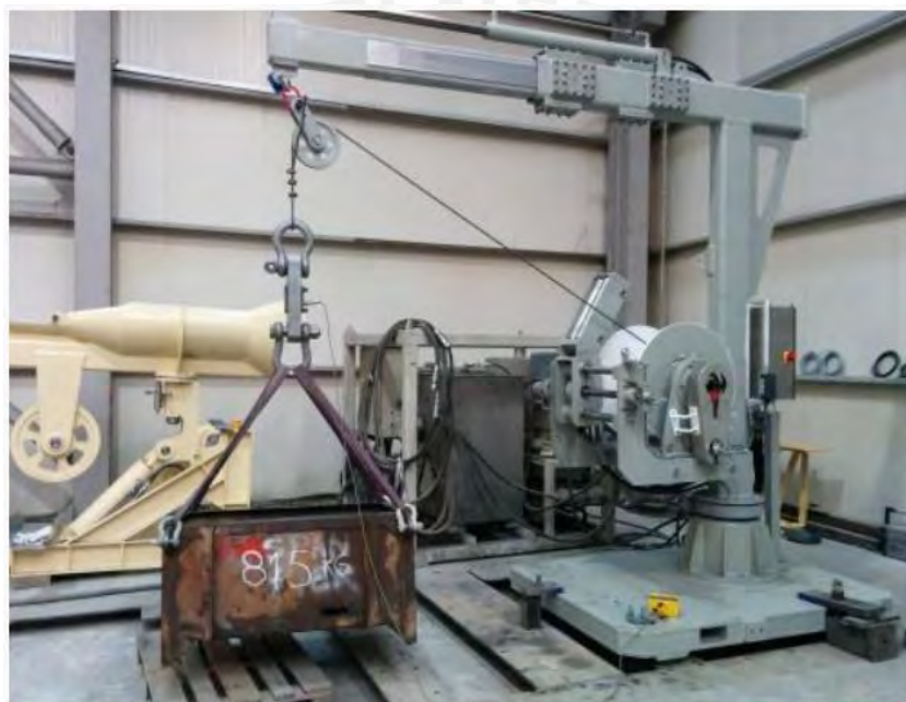
Figura 2.4: LARS subtipo Crane de OSIL. (Ocean Scientific International Ltd, s.f)
