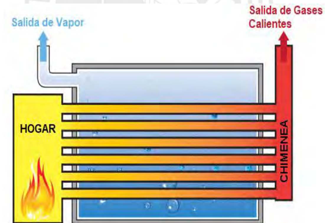
Figura 1.3. Diagrama de una caldera pirotubular. Adaptado del sitio web IB&M Boilers.
