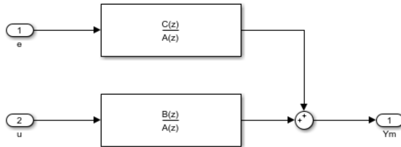
Figura 3.11. Modelo paramétrico con estructura ARMAX identificado de la caldera.
