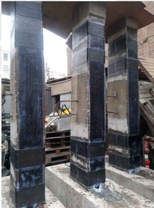
Figura 4.14. Colocación de última capa de epóxico en los especímenes reforzados. (Fuente: Propia)
