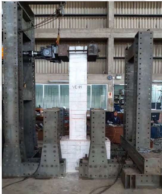
Figura 4.19. Disposición final para inicio de ensayo de carga cíclica. (Fuente: Propia)
