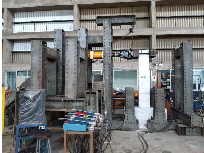
Figura 4.16. Montaje mecánico viga VE-03 para el inicio del ensayo. (Fuente: Propia)
