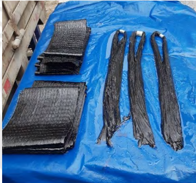
Figura 4.10. Bandas de fibra de carbono FRP y tiras de FRP para el anclaje en la zapata (Fuente: Propia)
