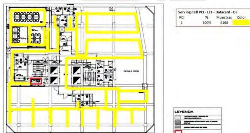
Figura 34: Traza PCI 1 identificando el cambio de Celda física DL.
