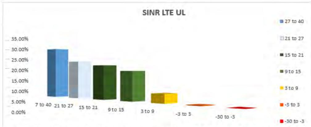
Figura 60: Grafico de columnas que muestra el SINR UL SMALL CELL OFF
