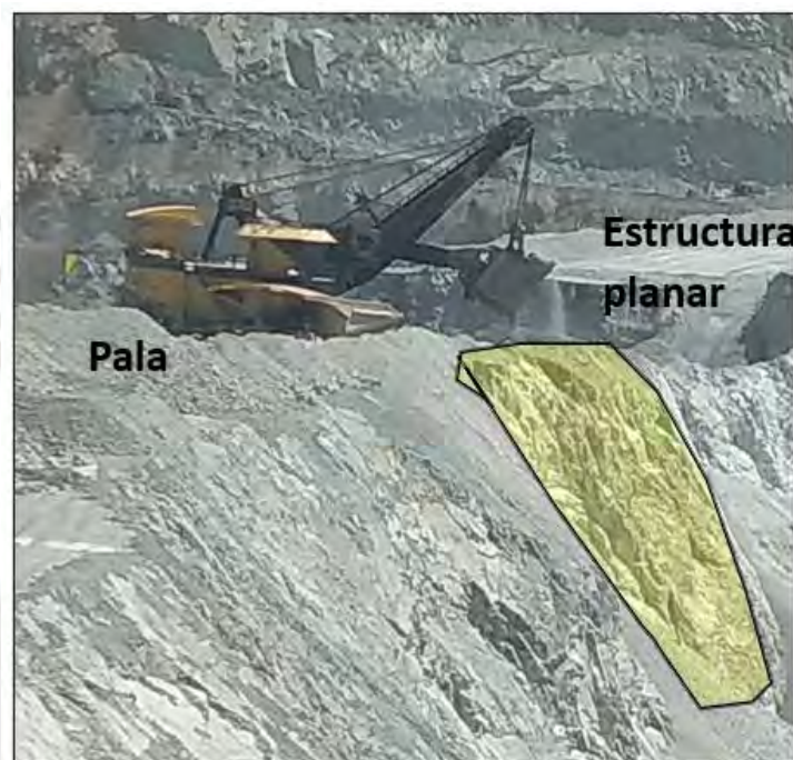
Figura 3.13 Interacción de pala con estructura tipo planar
