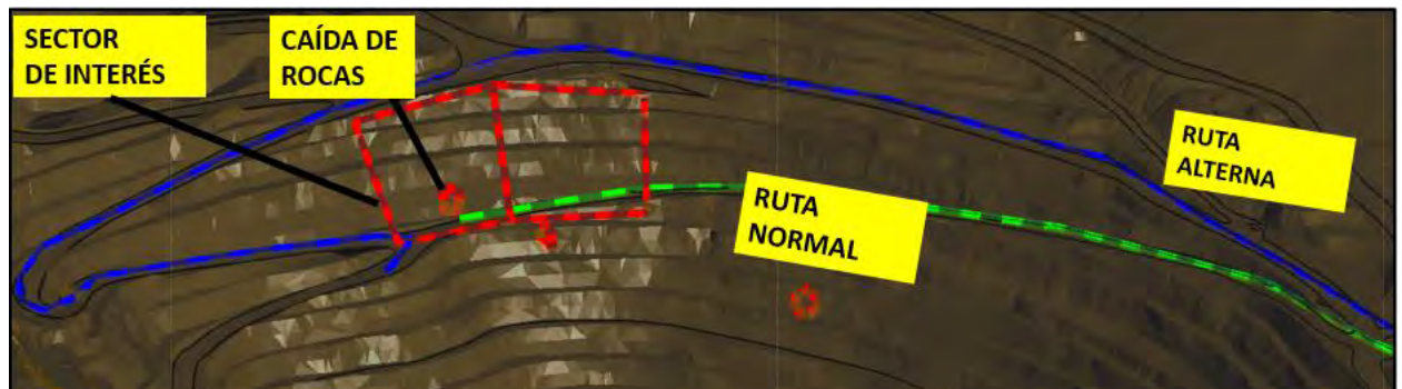
Figura 3.3 Ruta alterna para el tránsito de camiones debido a la restricción temporal de rampa noroeste del tajo a causa de caída de rocas.
