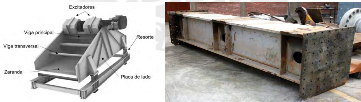
Figura 35. Esquema de zaranda vibratoria comercial (izquierda) y viga principal de zaranda suministrada para el análisis (derecha).
