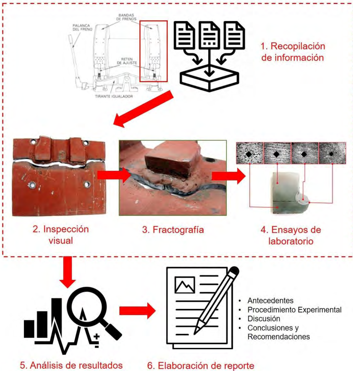
Figura 7. Representación de las etapas de un análisis de falla metalúrgico empleando el caso de la falla de una banda de freno de un winche. Fuente propia.
