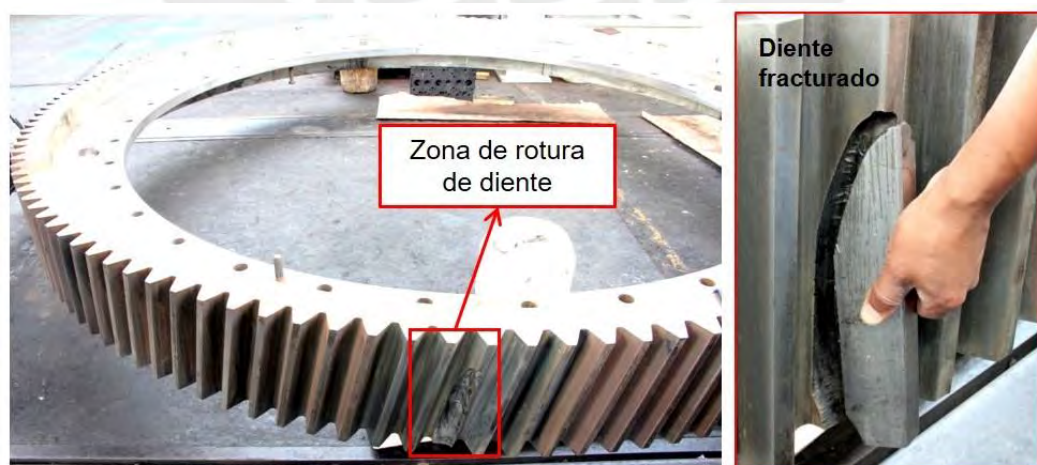
Figura 3. Diente fracturado debido a un deficiente tratamiento de bonificado.
