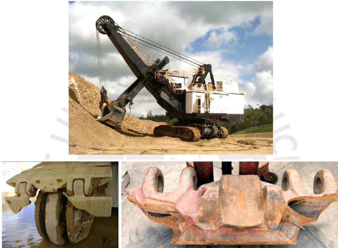
Figura 8. Fotografía de una pala excavadora en operación (arriba) [13], contraparte de zapata de oruga fracturada (abajo izquierda) y muestra enviada al laboratorio para el análisis (abajo derecha).
