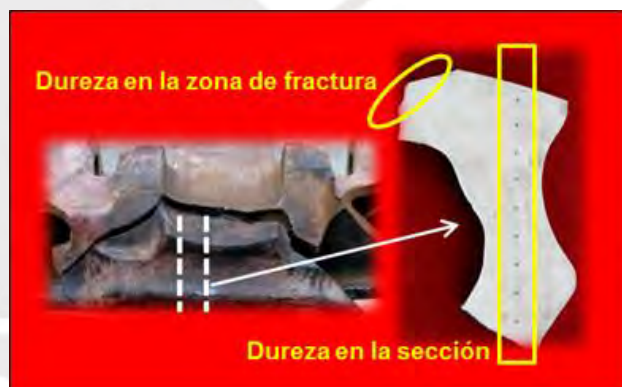
Figura 23. Muestra para los ensayos de dureza en la sección y en la zona de fractura.
