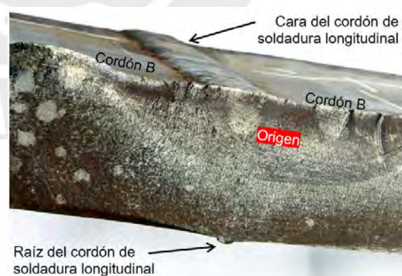
Figura 45. Superficie de fractura complementaria a la mostrada en la Figura 44.
