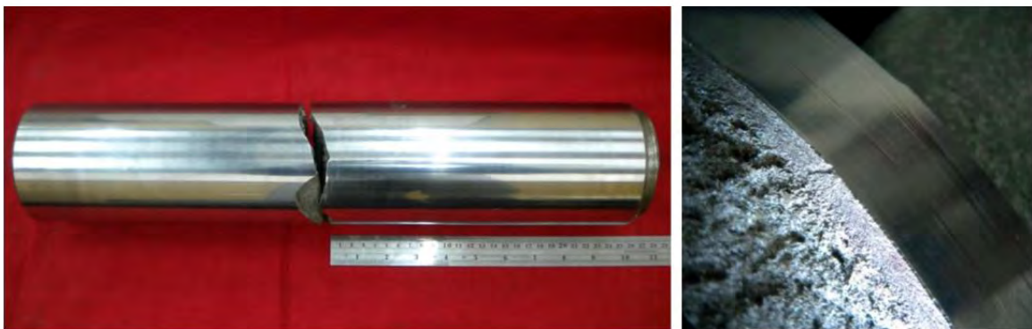
Figura 4. Vástago fracturado debido a la generación de elevados esfuerzos de flexión por una operación inapropiada. Fuente propia.
