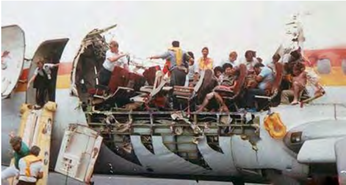
Figura 5. Estado del avión del vuelo 243 de Aloha Airlines cuyo fuselaje falló por un mecanismo de corrosión fatiga [10].
