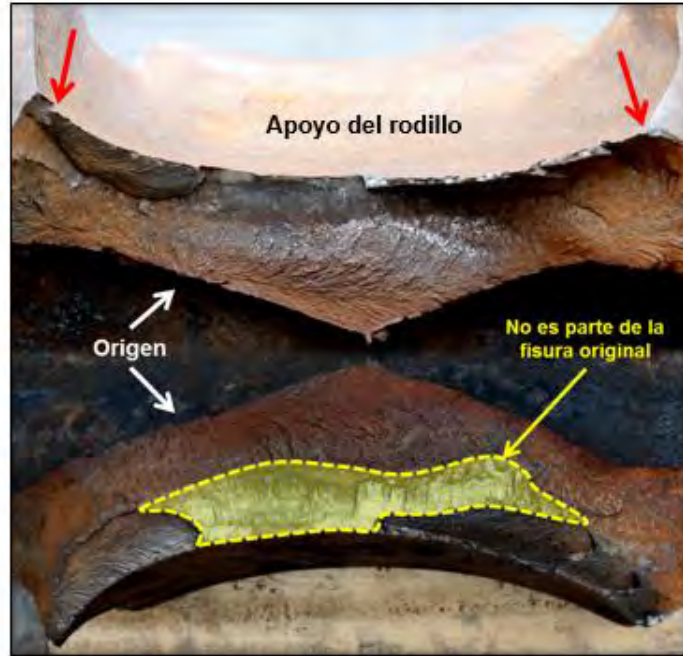
Figura 12. Superficies de fractura de Fisura 1.
