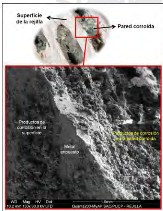
Figura 28. Intersección superficie/pared de agujero de la placa y correspondiente imagen MEB.
