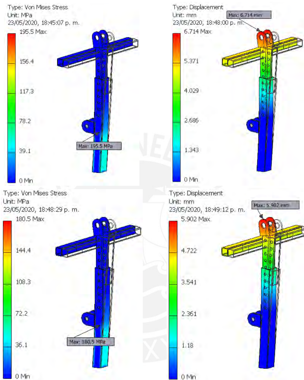
Figura C.5.. Esfuerzos y deformaciones para los primeros dos instantes críticos del perfil de soporte sin refuerzos.
