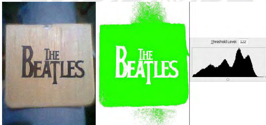
Figura 4.1-2: Umbralización de la imagen analizada 31
