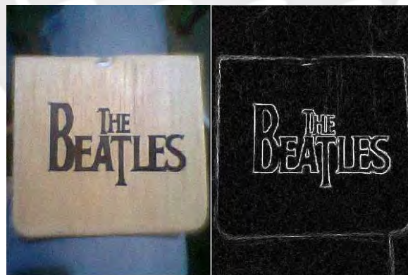
Figura 4.1-1: Imagen Original y la Imagen Procesada con los Bordes 30
