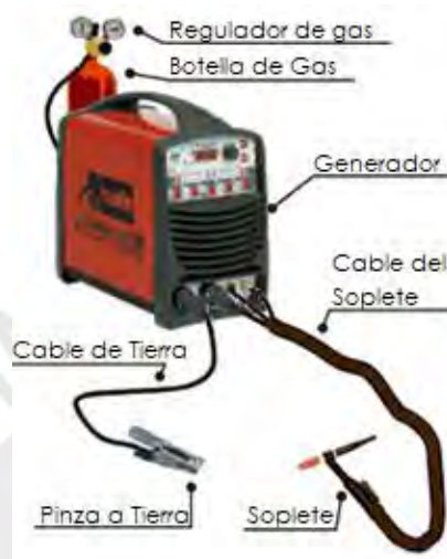
Figura 2.1-2: Elementos de soldadura GTAW 4
