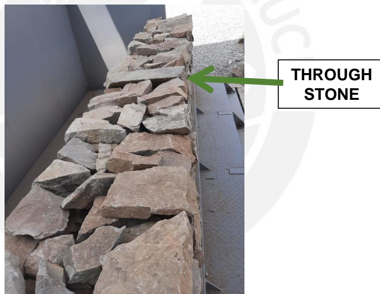
Figura 30. Through stone en pirca ensayada a escala natural. Fuente: Proyecto N° 109-2017-FONDECYT
