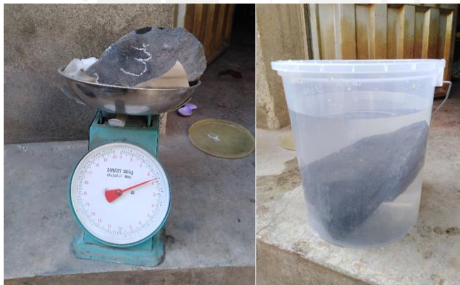
Figura 37. Calculo experimental de la densidad de la muestra 3
