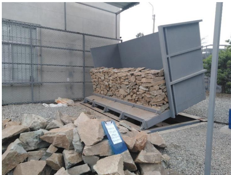
Figura 22. Mesa inclinable para ensayos estáticos, Campus USIL
