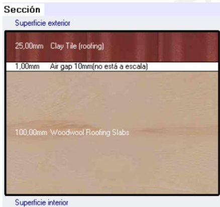
Figura 3.19: Sección de techo del segundo piso y propiedades térmicas
