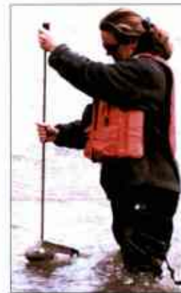
Figura 4 Muestreador integrador de sedimentos en suspensión 1 (Izquierda). Muestreo de sedimentos suspendidos en un río (Derecha). El mismo equipo se con varillas más largas y con lastre se aplica en cuerpos de agua de reservorios.
